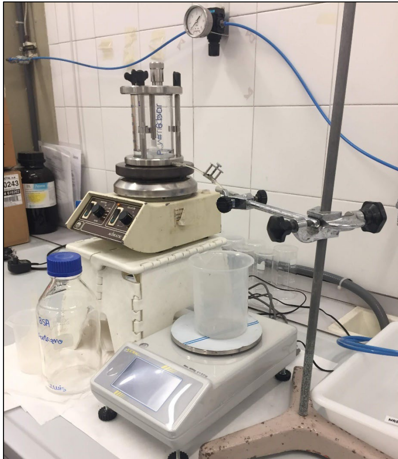
Figura 17. Montaje del módulo de membranas de ultrafiltración y balanza analítica
