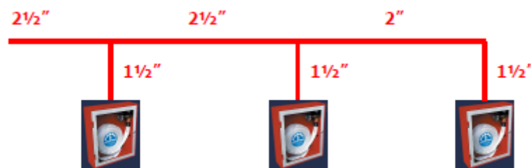
FIGURA 31: DIMENSIONADO TUBERÍAS BOCA DE INCENDIO EQUIPADAS
