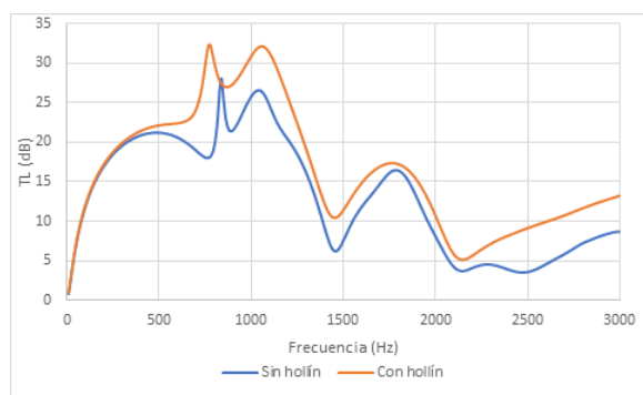
Figura 5.108: TL para monolito tipo 3 triangular con el conducto de salida centrado y 0,075 m de monolito (Análisis 76 y 80)
