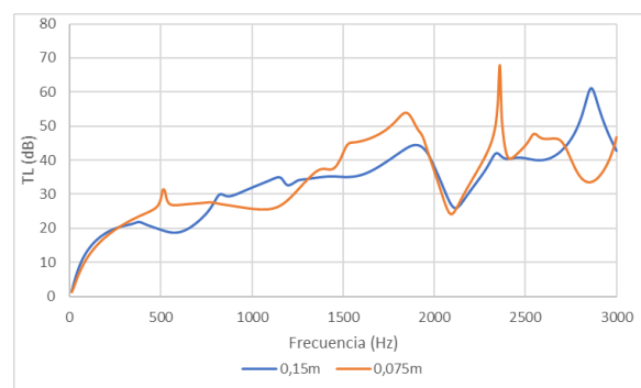
Figura 5.93: TL para monolito tipo 2 triangular con hollín y con el conducto de salida descentrado (Análisis 86 y 94)
