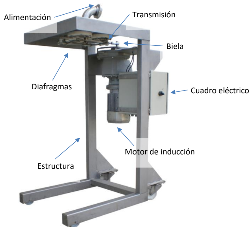
Ilustración 3. Formadora de diafragma 1FCD3 [6]
