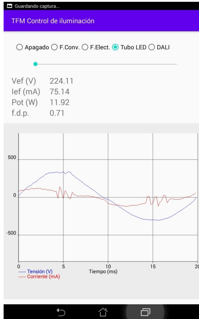
Figura 77. Aplicación con tubo led sin regulación en funcionamiento
