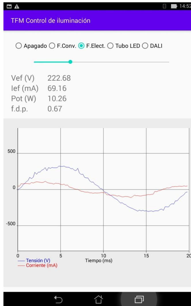
Figura 75. Aplicación con el tubo fluorescente con balasto electrónico y atenuación del 25 %
