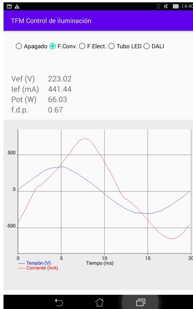
Figura 73. Aplicación con el tubo fluorescente con balasto convencional en funcionamiento
