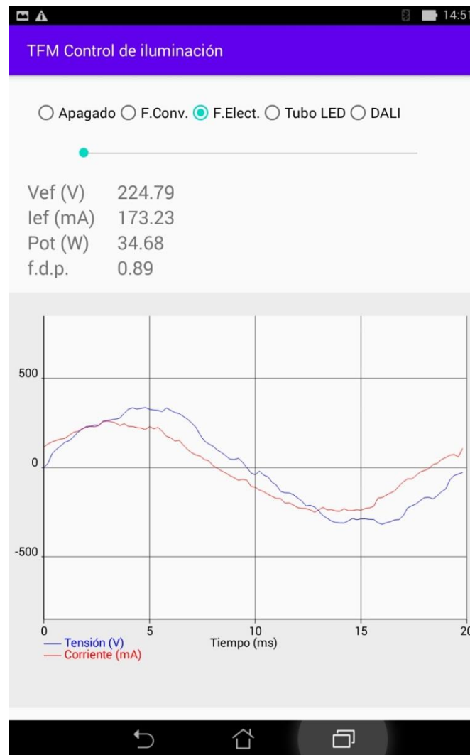
Figura 74. Aplicación con el tubo con balasto electrónico sin atenuación en funcionamiento
