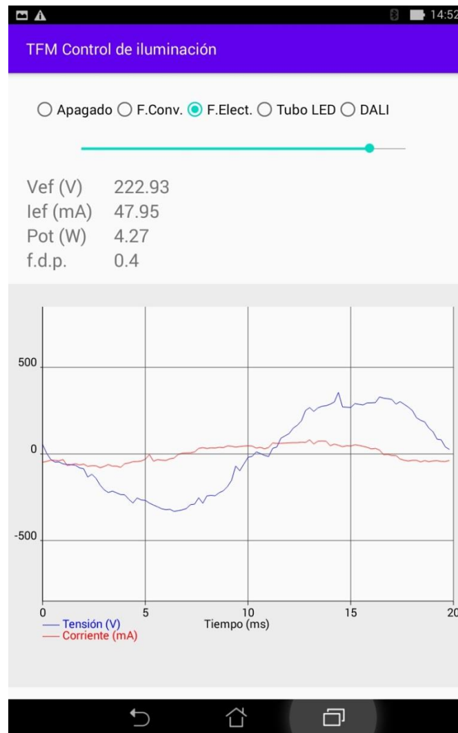
Figura 76. Aplicación con el tubo fluorescente con balasto electrónico y alta atenuación
