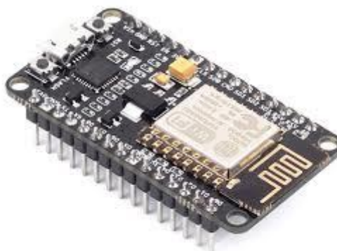
Figura 14. Placa de desarrollo ESP8266 NodeMCU Iolin. Fuente: electronilab.co
