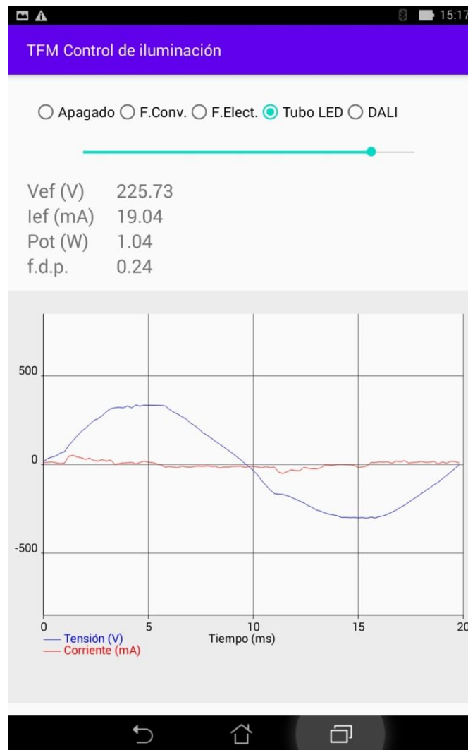
Figura 79. Aplicación con el tubo led con alta atenuación
