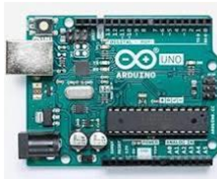
Figura 13. Arduino Uno R3. Fuente: amazon.com
