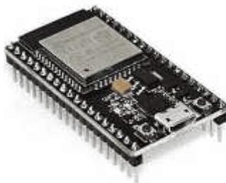
Figura 15. Placa de desarrollo ESP32 DevKit v1. Fuente: tiendatec.es
