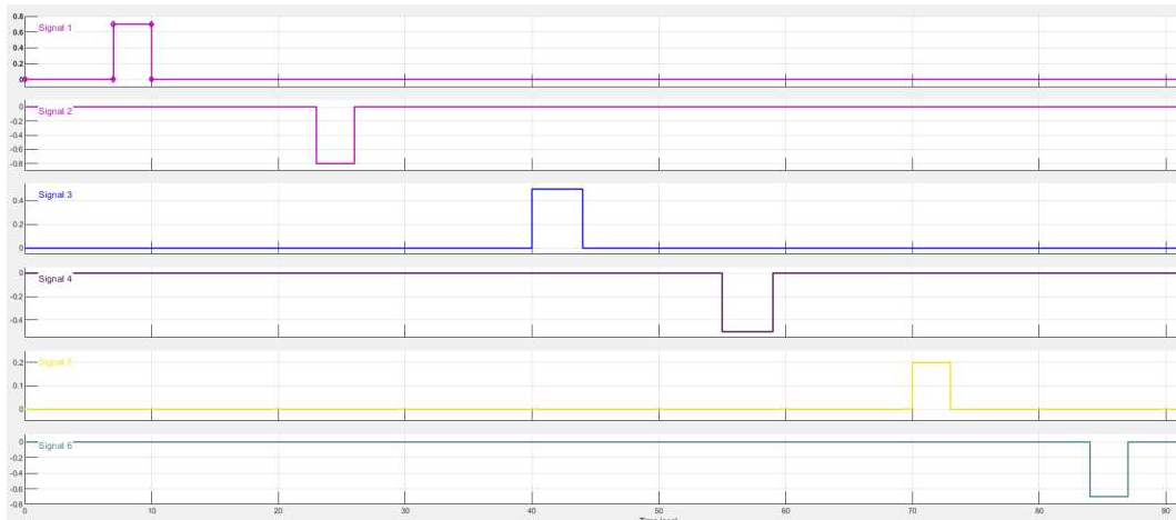
Ilustración 15. Señal utilizada para la identificación de Ghy. Las diferentes señales se aplican todas a la misma entrada en diferentes intervalos temporales, siendo la entrada real una sola señal. Fuente: Elaboración Propia
