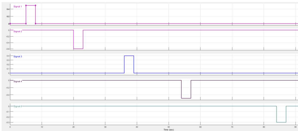
Ilustración 12. Señal utilizada para la identificación de Gyr. Las diferentes señales se aplican todas a la misma entrada en diferentes intervalos temporales, siendo la entrada real una sola señal. Fuente: Elaboración Propia
