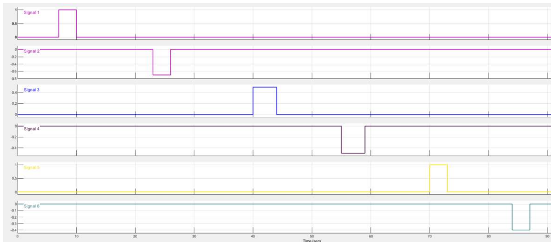
Ilustración 6. Señal utilizada para la identificación de Ghv. Las diferentes señales se aplican todas a la misma entrada en diferentes intervalos temporales, siendo la entrada real una sola señal. Fuente: Elaboración Propia
