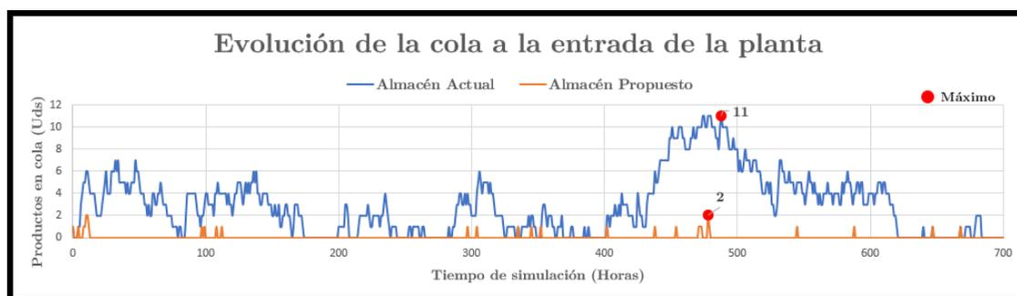
Figura 7.18: Evolución de la cola de productos a la entrada de la planta durante los escenarios 1 y 2 de la batería de experimentos 1. Fuente: Elaboración propia.
