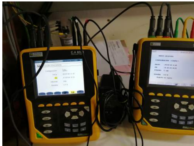
Figura 4.14: Analizadores de red.
