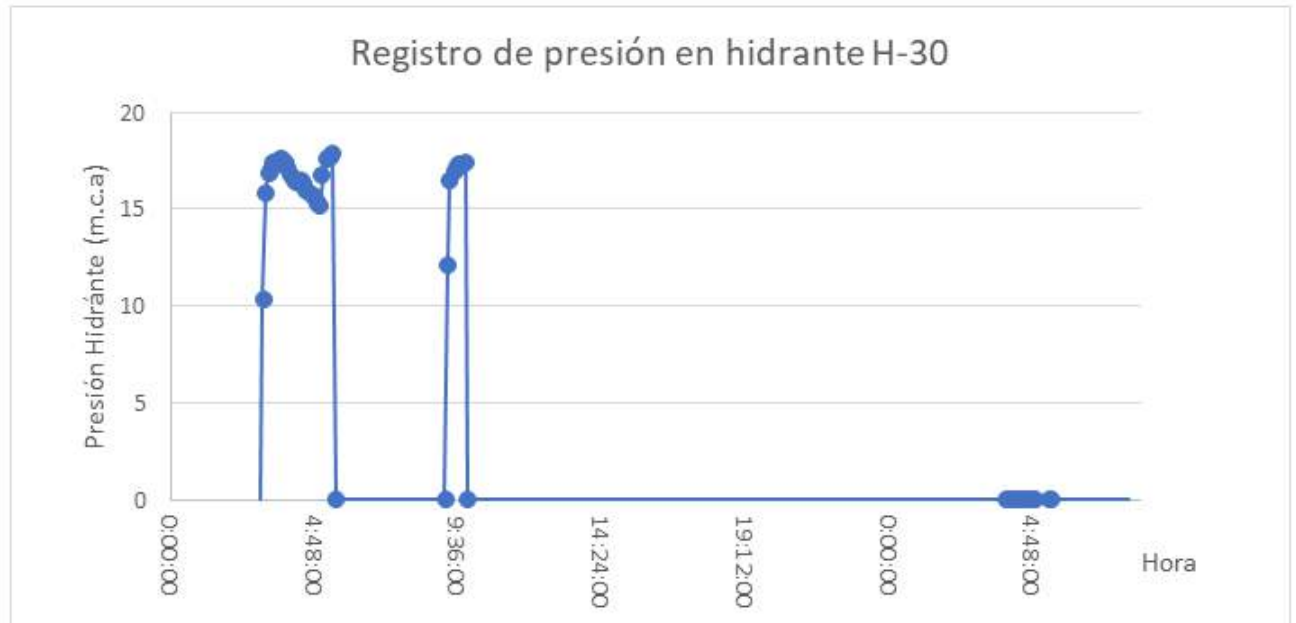
Figura 4.30: Presiones registradas en el hidrante 30, Sector 3.
