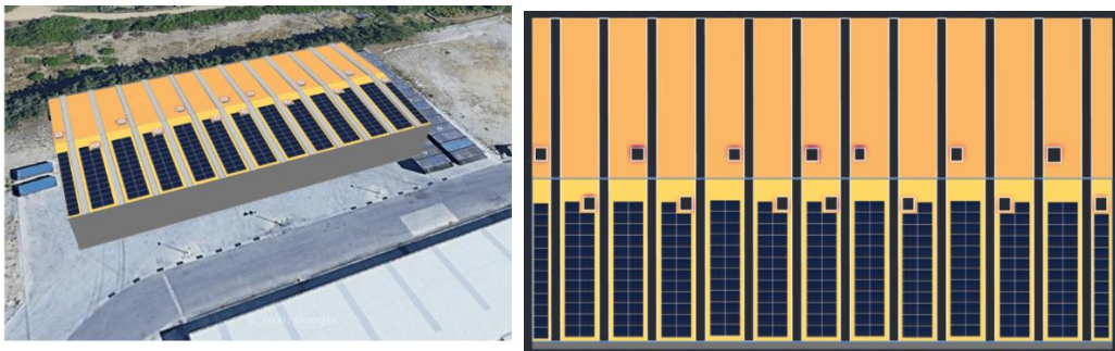
Figura 71. Mapa de irradiación en cubierta. (Solar Edge Designer, 2020)
