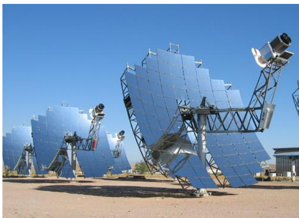
Fig. 4 Concentrador Solar de McDonell Corporation. (Fuente: www.stirlingenergy.com )
