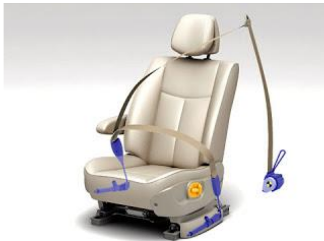
Figura I.1. Ilustración gráfica de la colocación de un cinturón de seguridad. De color azul se muestran los elementos que lo integran. 1
