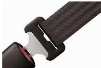
Figura I.12. Fotografía que muestra el sistema de bloqueo de cinturón de seguridad. 11
