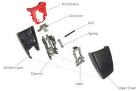
Figura I.16. Despiece de las partes del anclaje de un cinturón de seguridad. 15
