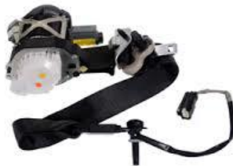
Figura I.14. Imagen de un sistema limitador de carga de cinturón de seguridad. 13
