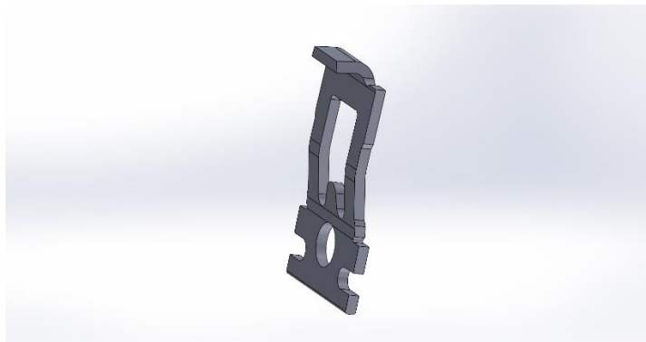
Figura III.17. Modelado en SolidWorks de la pieza de enganche
