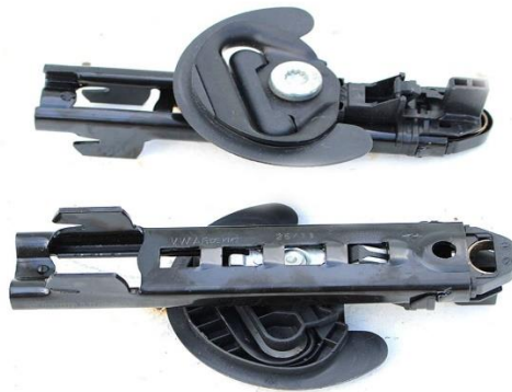
Figura I.8. Fotografía de un sistema regulador de altura del cinturón de seguridad. 7
