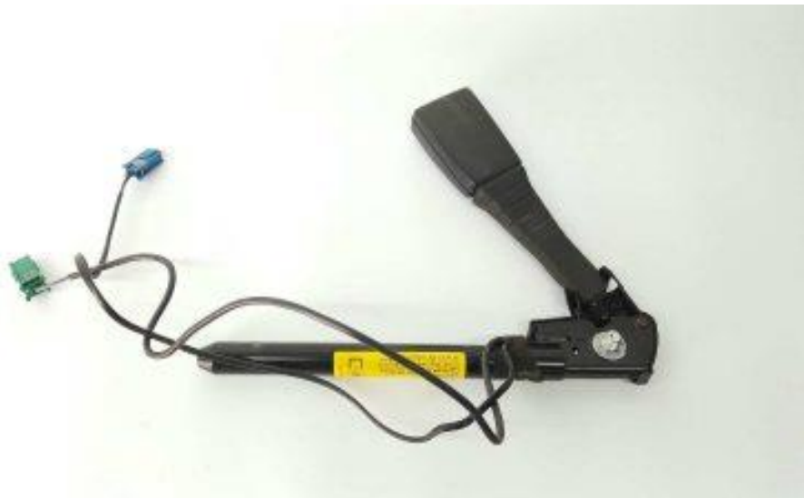
Figura I.6. Fotografía de un pretensor y anclaje del cinturón de seguridad. 5
