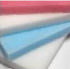
La espuma de polietileno es una poliolefina de base polietileno. Para obtener esta espuma se utiliza un gas hinchante, normalmente isobutano. Se consigue un polietileno expandido manteniendo sin transformar la estructura química del polietileno y así, facilitar su reciclabilidad.
