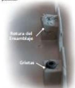
Fig.7. Rotura de manguitos ocasionadas por el roscado de un tornillo rosca chapa sobre un pieza de poliéster + 30% Fibra de Vidrio.
