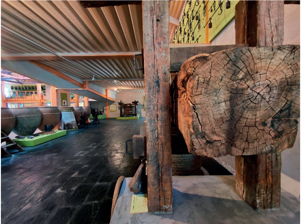
Figura 3. Prensa de viga y aclaradores. Sistema de producción tradicional.
