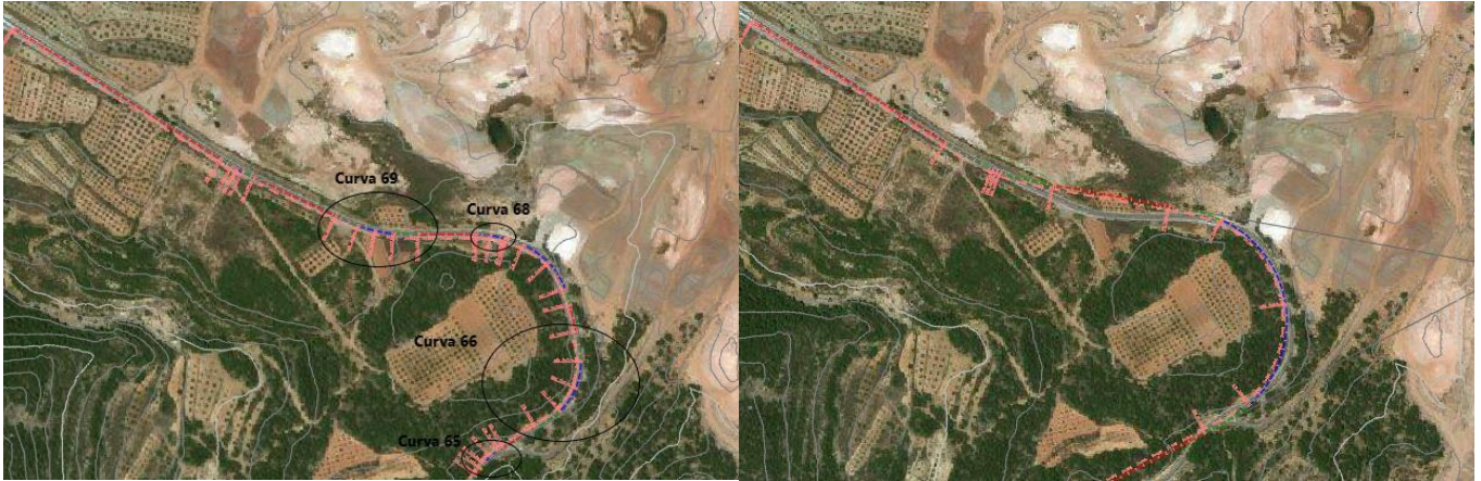
Figura 47. Situación actual y propuesta del trazado. Fuente, Civil 3D
