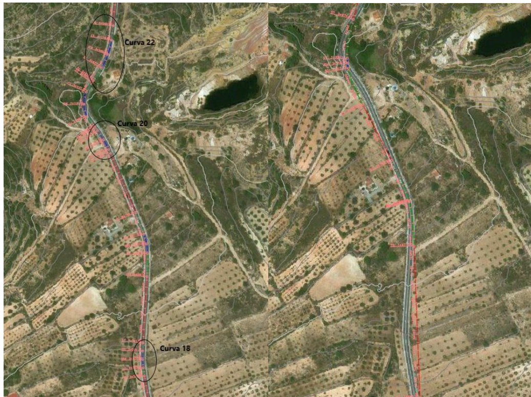
Figura 42. Situación actual y propuesta del trazado. Fuente, Civil 3D
