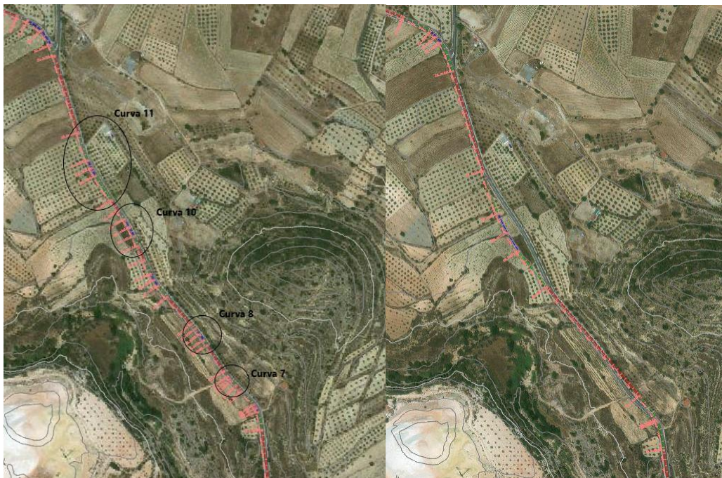
Figura 40. Situación actual y propuesta del trazado. Fuente, Civil 3D
