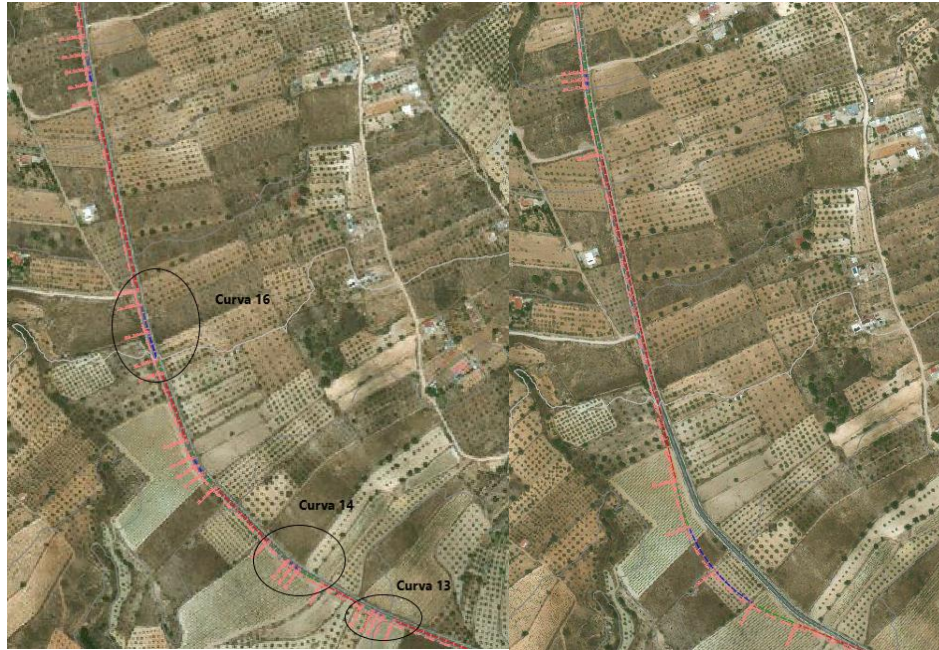
Figura 41. Situación actual y propuesta del trazado. Fuente, Civil 3D
