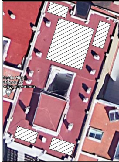
Figura 30. División de una cubierta en rectángulos libres de obstáculos.
