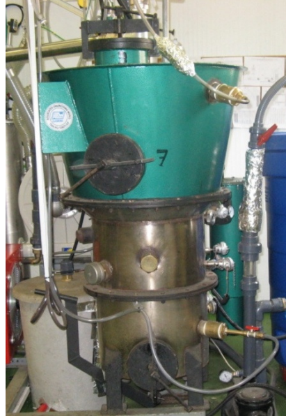
Figura 3.3 Reactor del gasificador de lecho fijo downdraft
