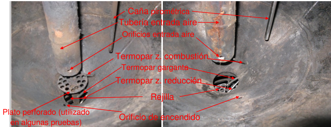
Figura 3.6 Configuración de 4 agujeros de entrada de aire a la zona de combustión
