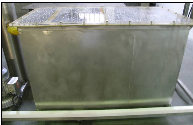
Figura 3.46 Lavador de gas, filtro de gruesos y filtro de finos
