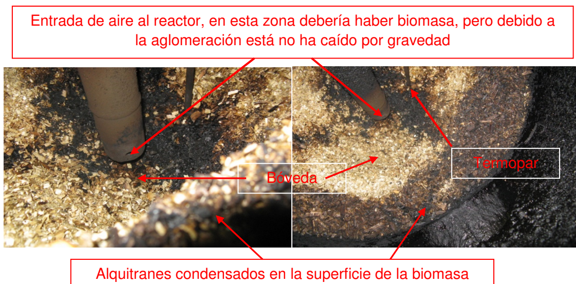
Figura 4.2 Bóvedas formadas en el reactor de lecho fijo
