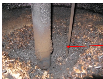
Figura 3.5 Residuo carbonoso de pellets pirolizados en el depósito de biomasa
