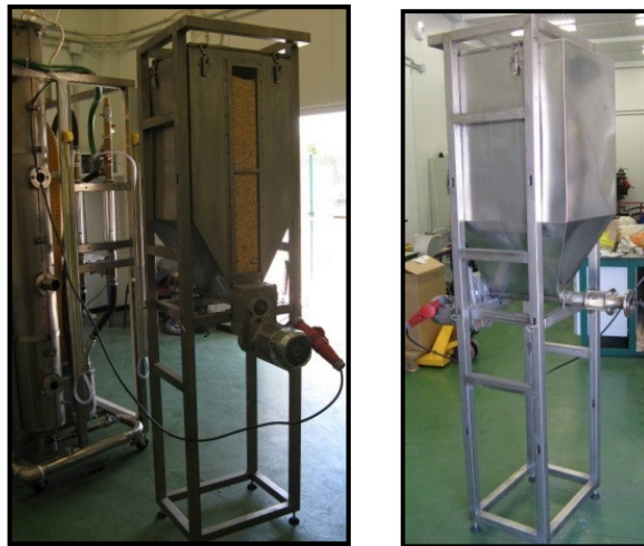
Figura 3.31 Tolva de alimentación de Biomasa
