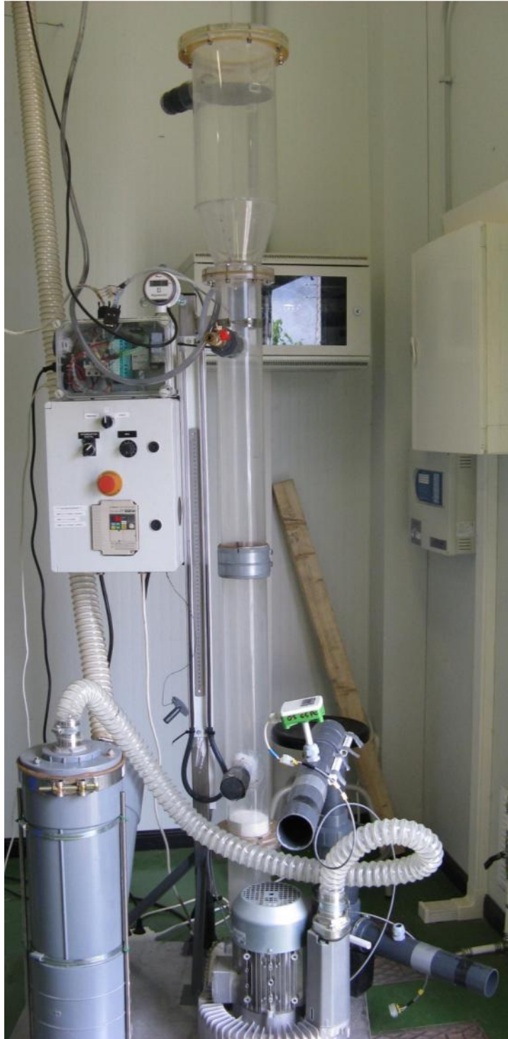
Figura G.17 Reactor para realizar pruebas de fluidización en frío
