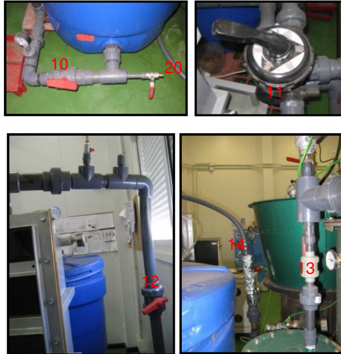
Figura C.4 Válvulas del circuito de agua
