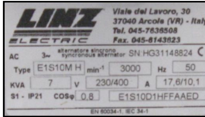
Figura A.8 Placa del generador de energía eléctrica acoplado al motor Honda GX390
