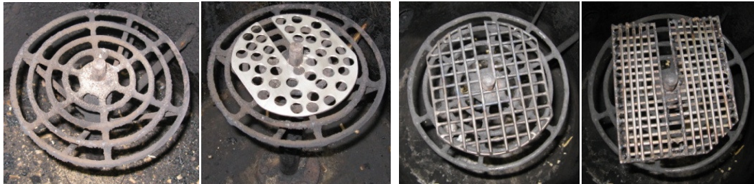
Figura 3.11 Rejilla intercambiable sobre la fija (1. Sin rejilla; 2. D_o = 1\text{cm} ; 3. 1,1x1,1 cm; 4. 0,6x0,6 cm
