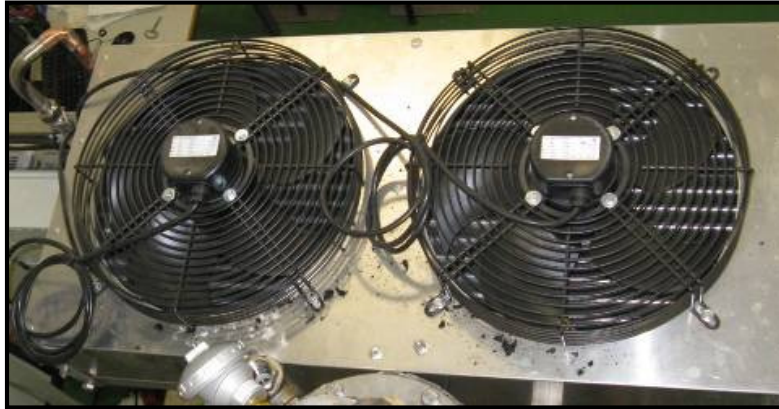
Figura 3.52 Aerotermo (Intercambiador Agua-aire)
