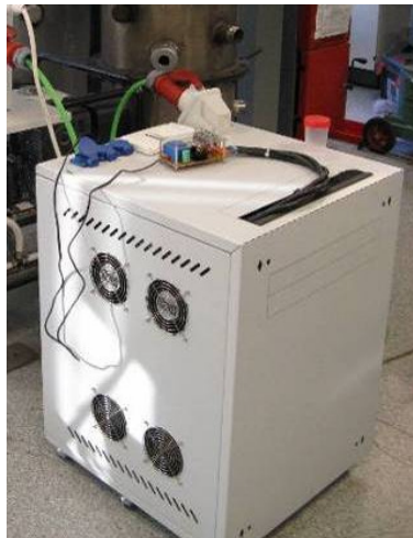
Figura 3.20 Simulador de carga mediante resistencias eléctricas
