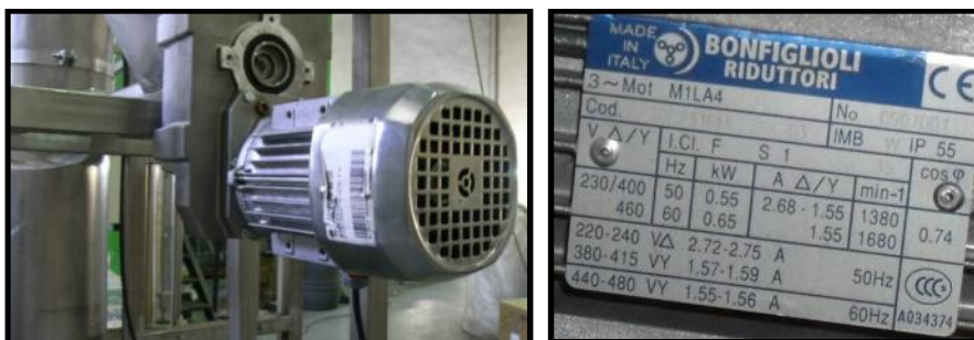
Figura A.33 Motor del tornillo sinfín y datos de placa del motor
