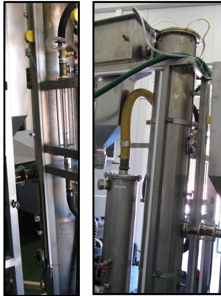
Figura 3.40 Manómetro diferencial para controlar caída de presión del lecho
