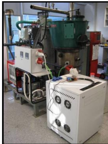
Figura A.9 Simulador de carga mediante resistencias eléctricas
