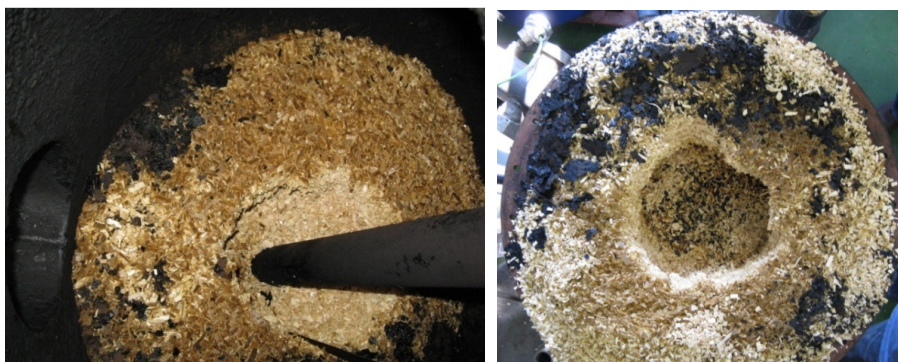
Figura 3.7 Bóvedas formadas utilizando astillas como combustible
