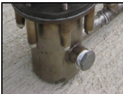
Figura 4.5 Orificio de encendido cercano a la biomasa en la base del reactor
