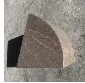
Figura 32: Bloque diagonal con corte curvo en perspectiva
