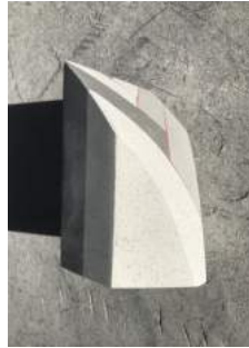
Figura 39: Patrón en espiga con corte curvo en perspectiva
