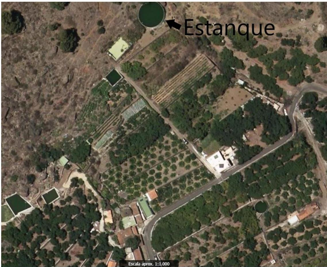
Como se observa en la “figura 8” el estanque seleccionado para la instalación fotovoltaica esta muy próximo a la mayor acumulación de viviendas, lo que lo hace ideal para realizar la instalación ya que se abaratarán los costes de la red de distribución.
