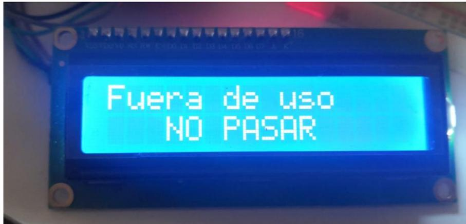
**Figura 21. Mensaje mostrado por pantalla cuando no se puede leer el DHT22**
