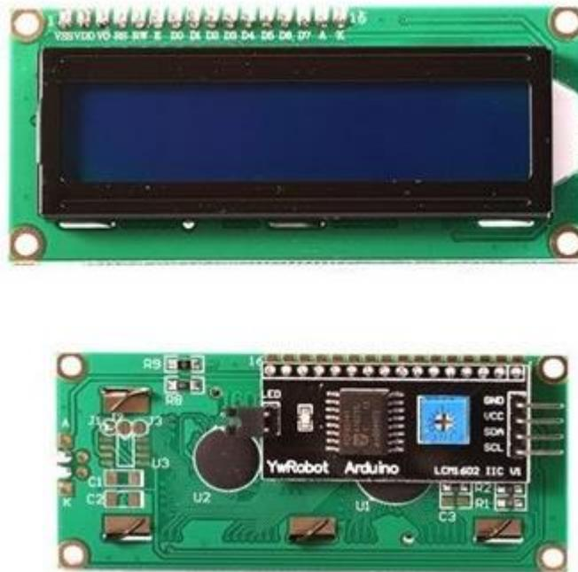
**Figura 5. Pantalla LCD con módulo I2C**
