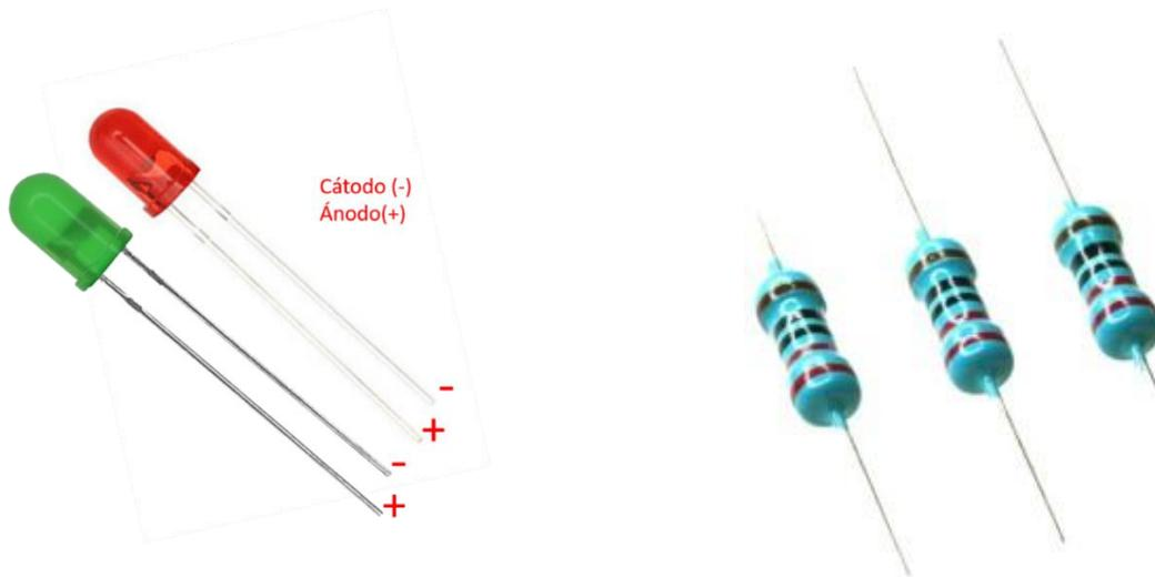
**Figura 6. Diodos LED (izquierda). Resistencias 220 Ohm (derecha)**
