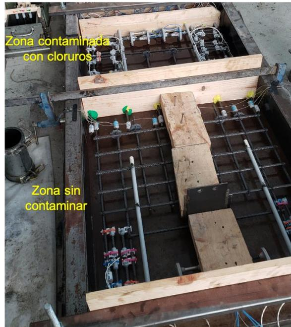
*Figura. 3-8. Encofrado de losa de hormigón, separación de zonas (fuente propia).*
