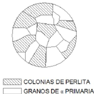
Figura. 2-11. Microestructura acero ( $\alpha$ : Ferrita). (Martínez Ibernón, 2017)
