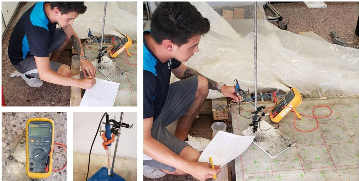
Figura. 4-7. Proceso de medidas de potenciales eléctricos (fuente propia).
