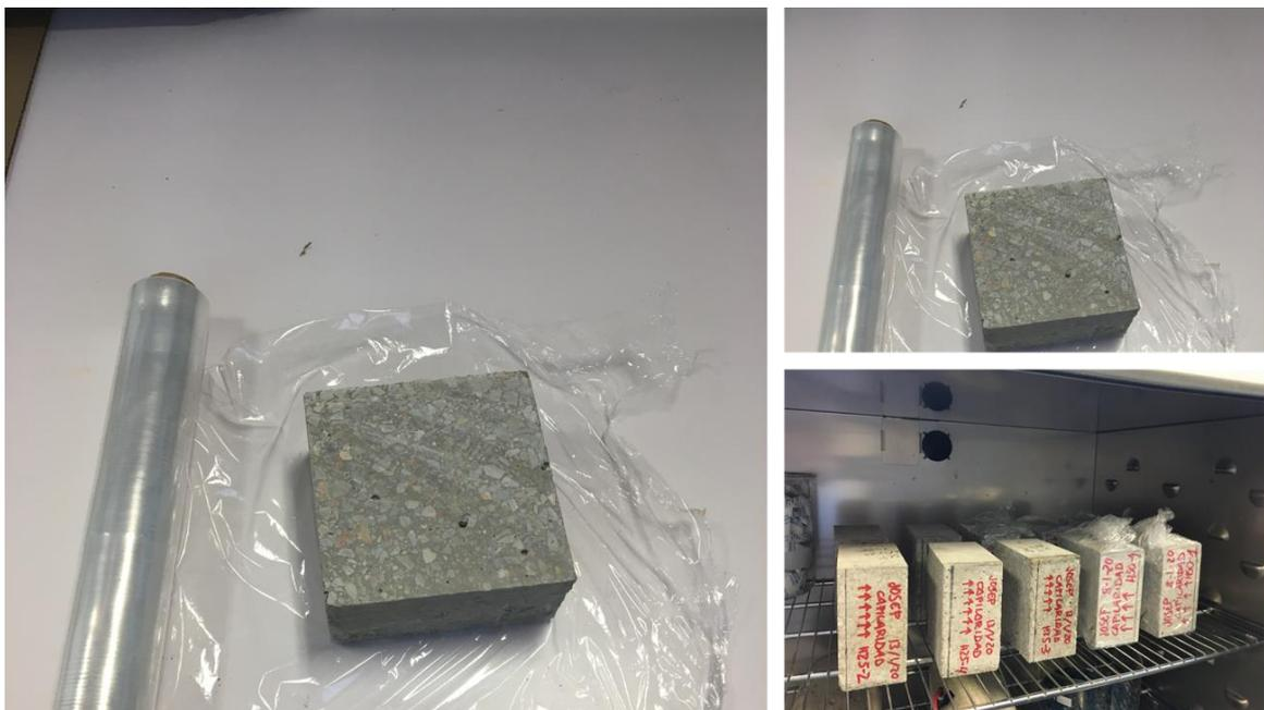
Figura. 4-2. Proceso de acondicionamiento de probetas según UNE 83966. (fuente propia).
