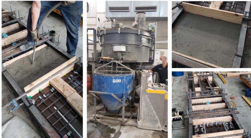
Figura. 3-10. Hormigonado zona contaminada Cl- (fuente propia).
