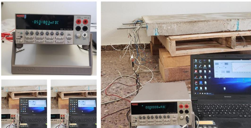
Figura. 4-8. Medida con amperímetro de resistencia nula (ZRA)(fuente propia).
