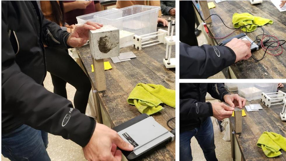
Figura. 4-5. Ensayo de resistividad eléctrica según norma UNE 83988-1 método directo (fuente propia)
