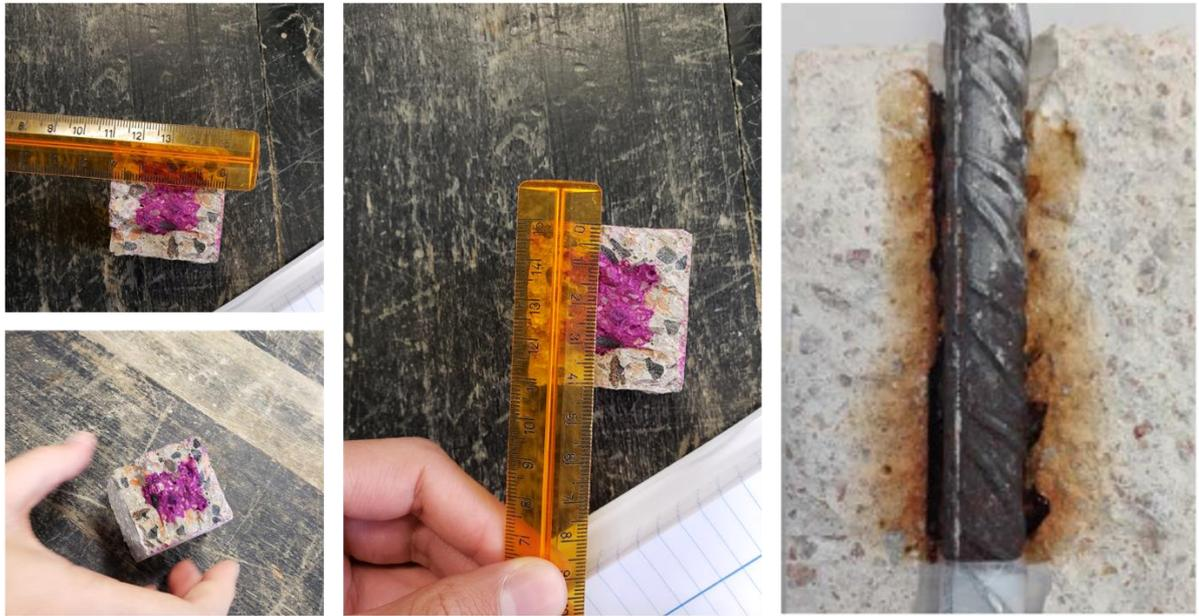
Figura. 2-7 Carbonatación en el hormigón. (fuente propia).
