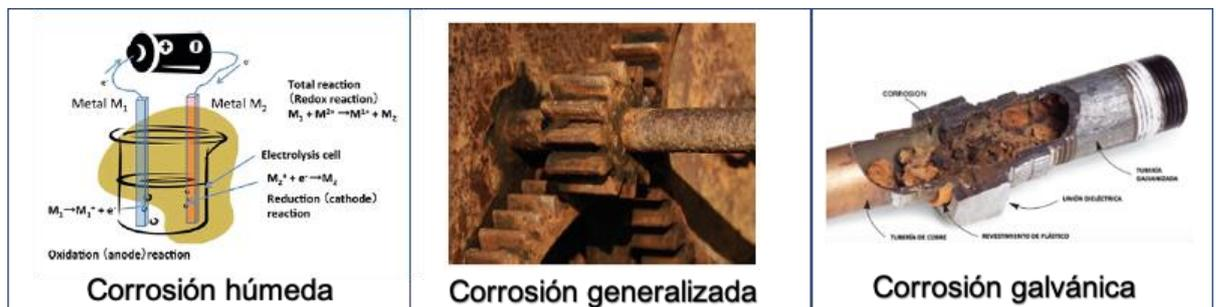
Figura. 2-1. Algunos tipos de corrosión. Imagen adaptada de (Kanematsu & Barry, 2016) y (Universidad de Cantabria)
