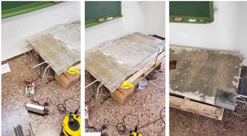
Figura. 3-15. Humectación de la losa (fuente propia).
