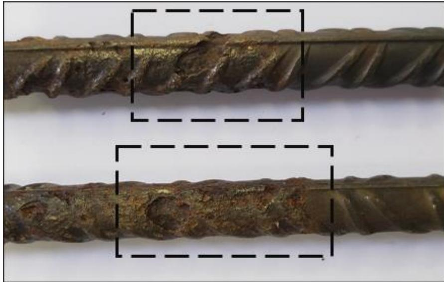
Figura. 2-9. Corrosión en acero por picadura. (fuente propia)
