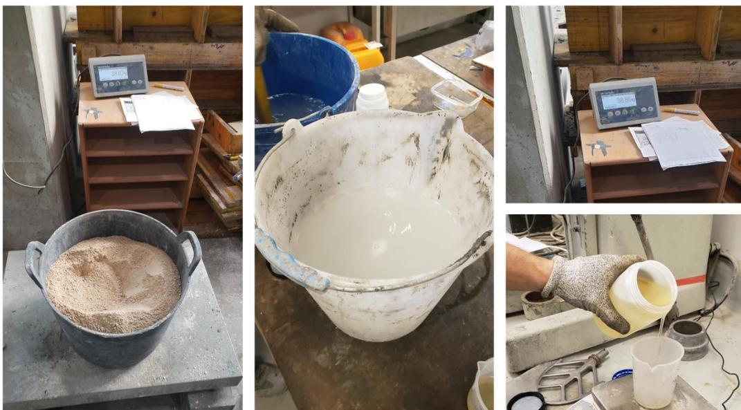
Figura. 3-7. Preparación de material para la primera amasada. (fuente propia)
