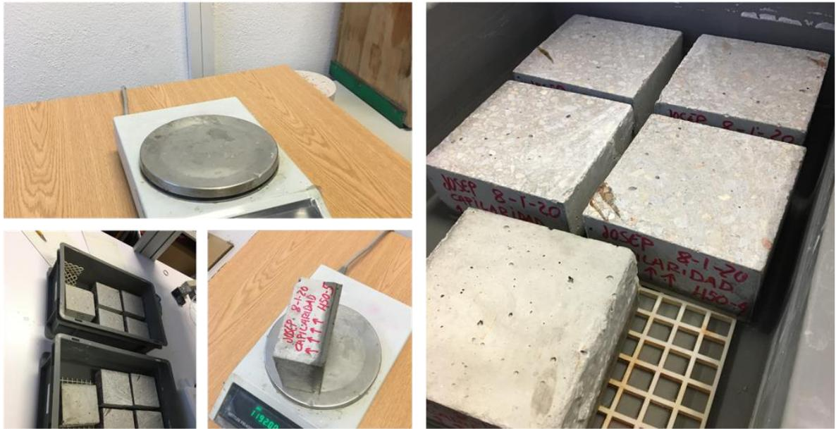
Figura. 4-3. Absorción de agua por capilaridad norma UNE 83982 (fuente propia).
