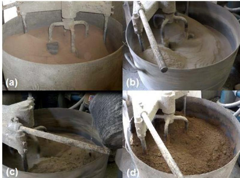
Fig. 10 Proceso de amasado de los bloques estabilizados con cemento.<sup>54</sup>
