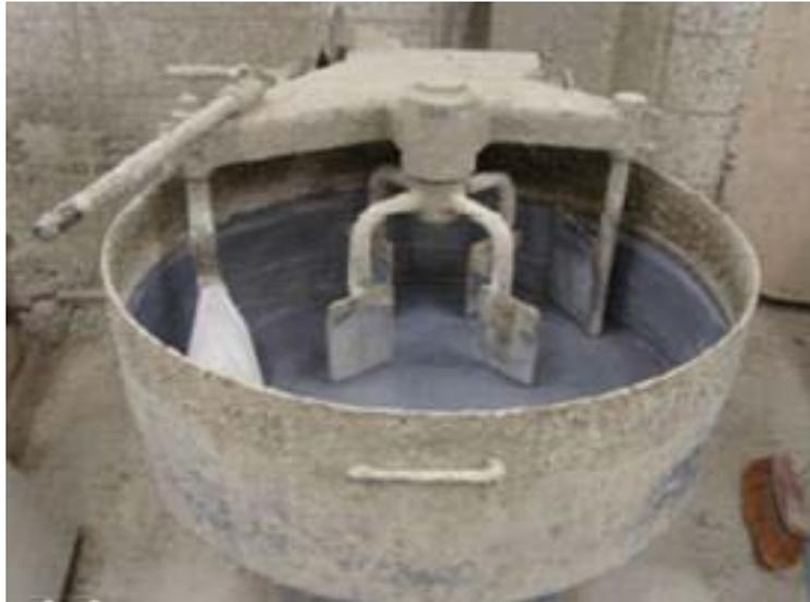
Fig. 7 Amasadora planetaria Ibertest M100 <sup>54</sup>
