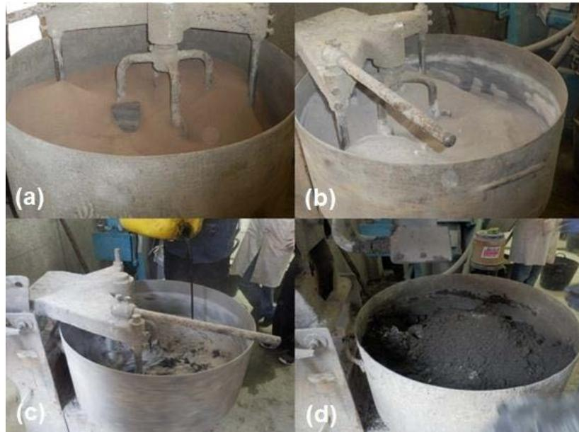
Fig. 9 Proceso de amasado de los bloques estabilizados con geopolímero.<sup>54</sup>
