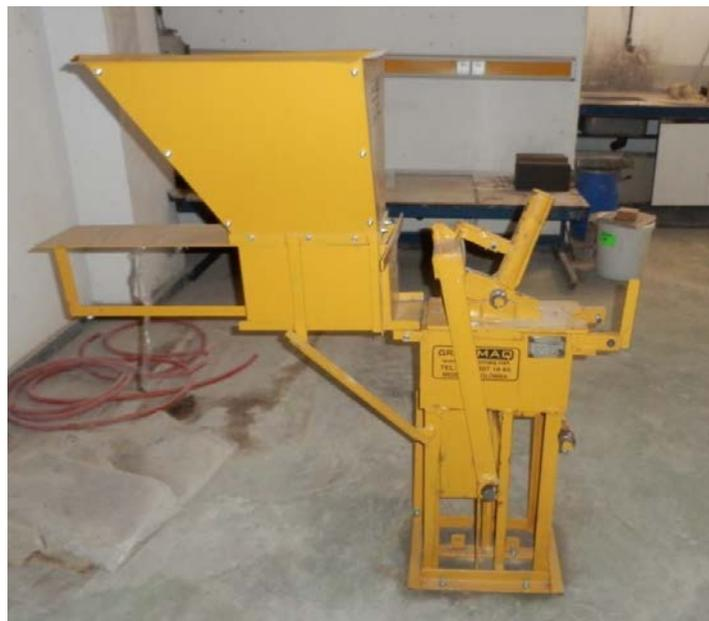
Fig. 8 Máquina CINVA-RAM utilizada para realizar los bloques. <sup>54</sup>
