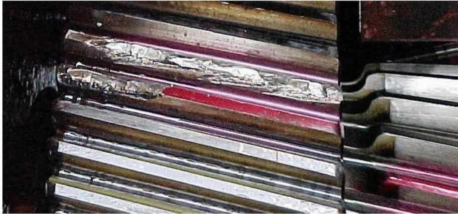
**Figura 7.14.-** Degradación de ruedas dentadas.
