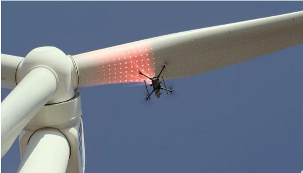
**Figura 2.2.-** Dron realizando verificación de palas de aerogenerador.
