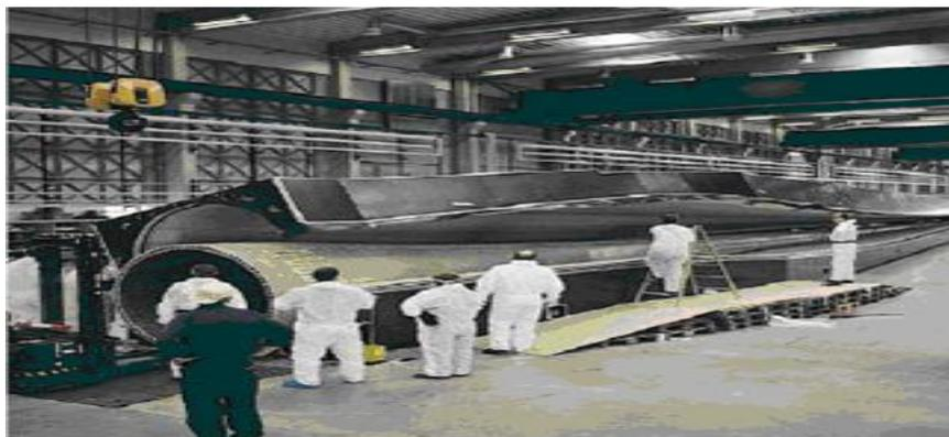
**Figura 7.5.-** Proceso de fabricación de una pala
