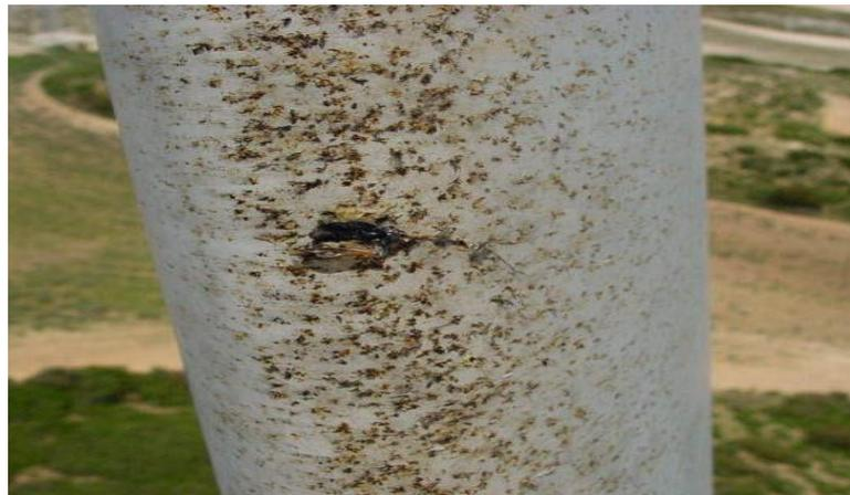
**Figura 7.12.-** Pala con restos de insectos y erosión con oxidación en superficie.
