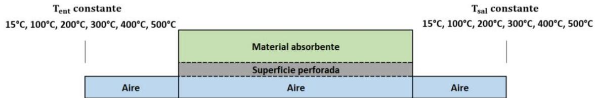
Figura 11. Temperatura constante en el interior del silenciador.
