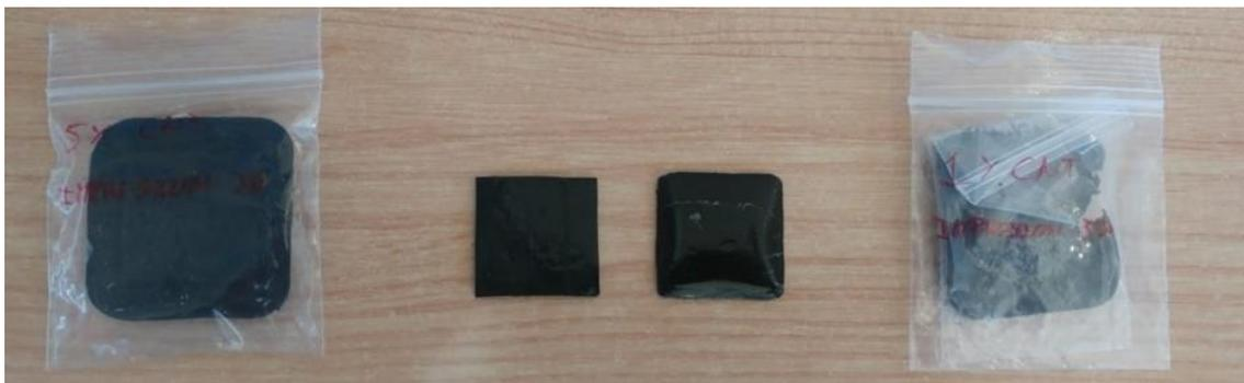
**Figura III.32.** Placas rectangulares obtenidas por impresión 3D a partir de los nanocompuestos y monofilamentos desarrollados previamente (Izda. 5% CNFs; Dcha. 1% CNTs)
