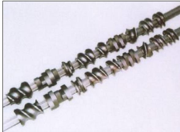
**Figura III.22.** Husillos ensamblados a los largo de un eje conformando el tornillo
