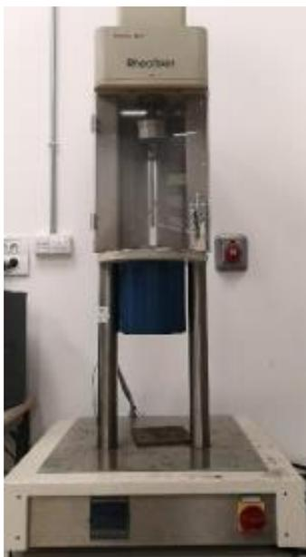
**Figura III.35.** Reómetro modelo Rheoflizer
