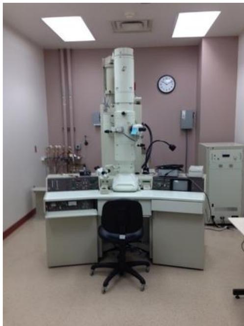
**Figura III.37.** Microscopio TEM marca JEOL modelo JEM-2010
