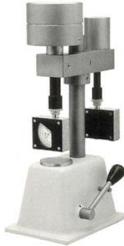
**Figura III.34.** Equipo J. Bot Instruments para la medida de la dureza Shore de materiales
