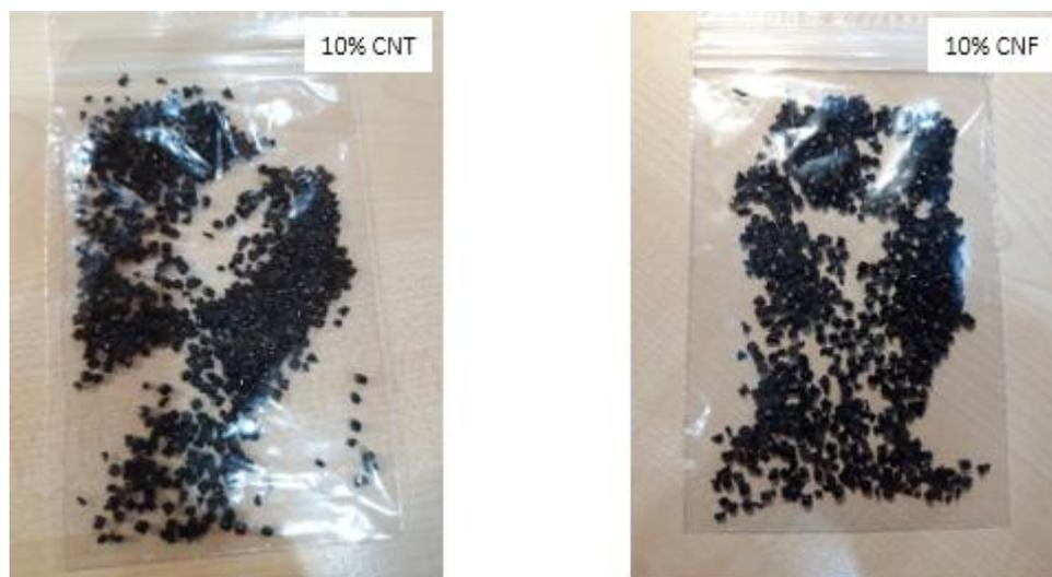
**Figura III.28.** Distintas granzas de Polipropileno funcionalizadas durante el trabajo
