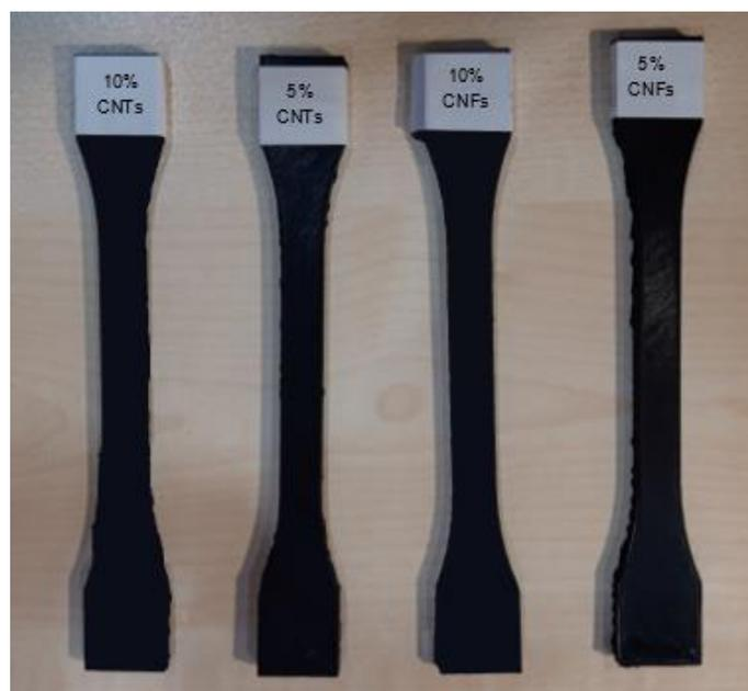
**Figura III.29.** Distintas probetas de tracción inyectadas.
