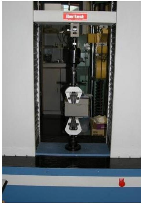
**Figura III.33.** Equipo de tracción Elib 50 de Ibertest.
