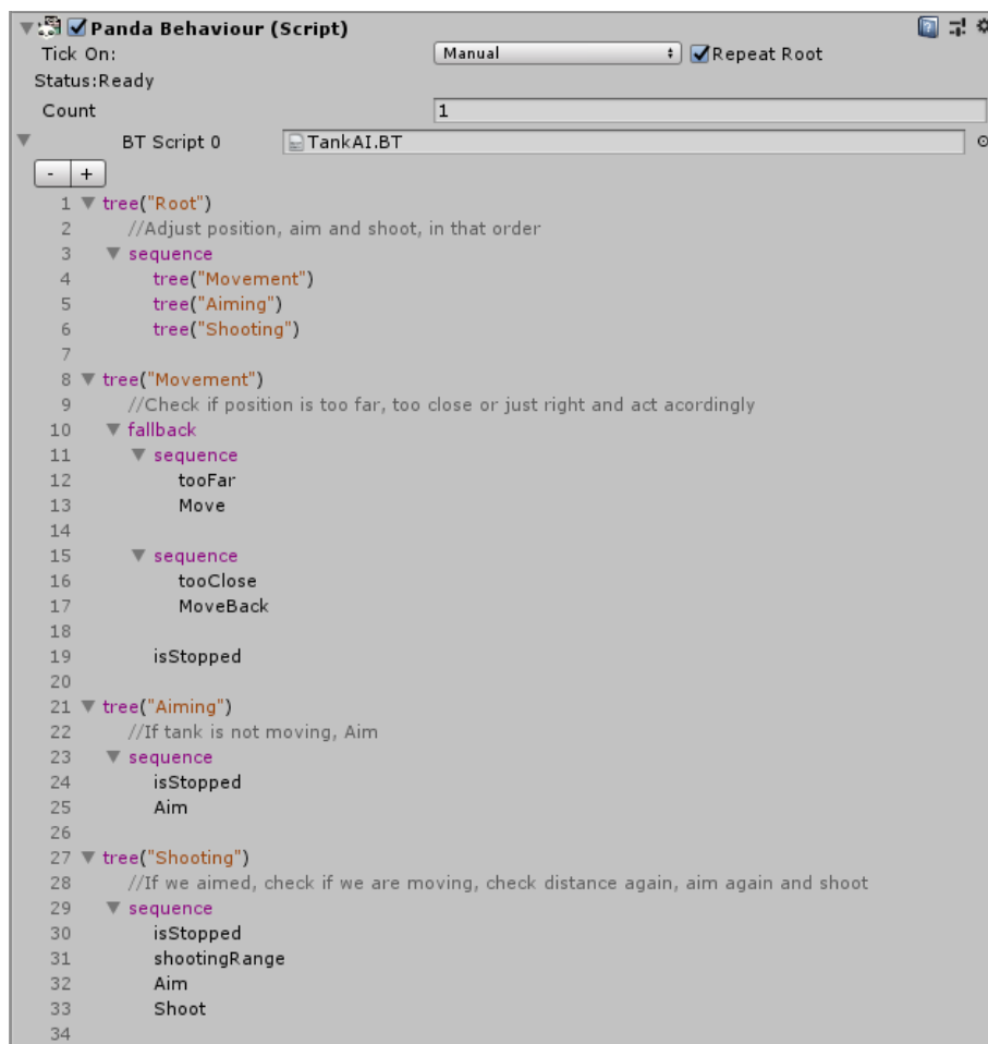
Ilustración 14. Componente de Panda BT Free en Unity con visualizador del árbol. Fuente propia.
