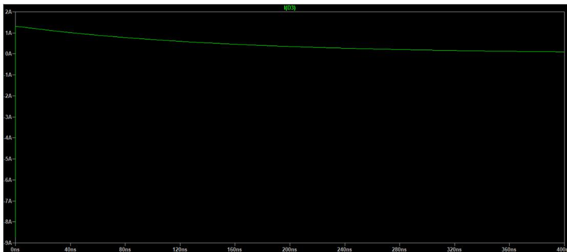
Imagen 25- Corriente por el diodo D3 tras aplicarle una ESD HBM de 2 kV
