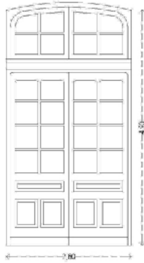
Fig. nº 338.- Alzado puerta de fachada principal. Estación de Valencia. (A. propio 2011).
