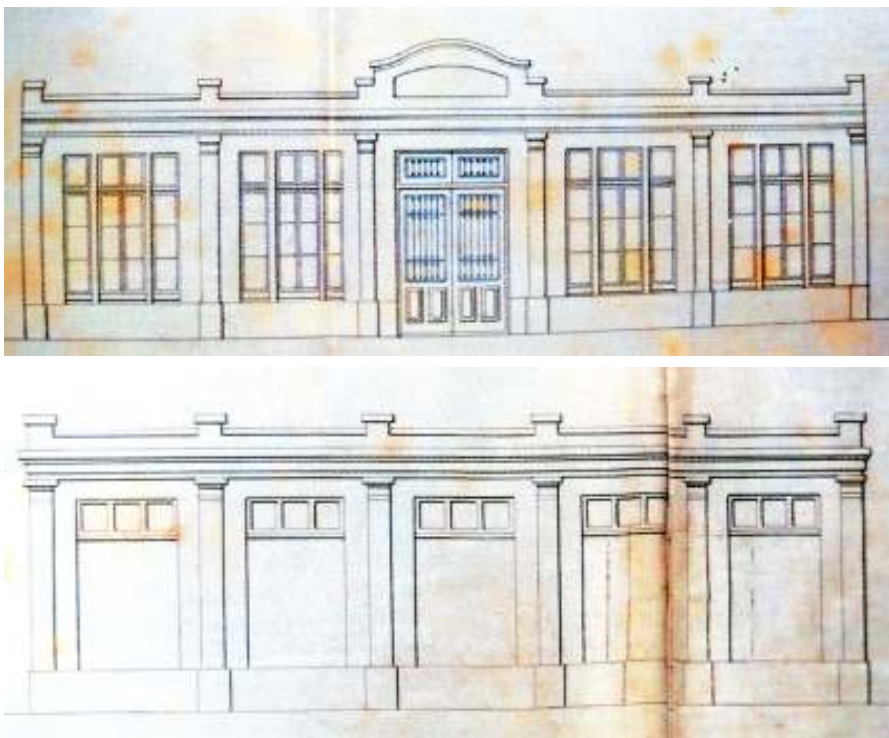
Fig. nº 50 y 51.- Alzado principal y alzado chafalán ed. almacén-oficina C/ Teruel (Valencia). "Demetrio Ribes". I. Aguilar.
