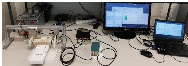
Figura 133. Montaje utilizado para las medidas de velocidad de onda P y atenuación en las probetas de mortero gris y blanco.
