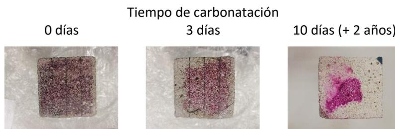
Figura 155. Espesores de la capa carbonatada después de sufrir procesos de carbonatación.
