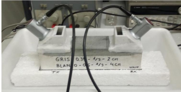
Figura 147. Acoplamiento localizado por agua mediante cuñas de 40° en la probeta de 20 mm de mortero gris.
