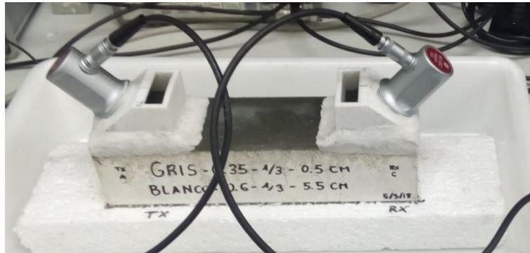
Figura 143. Acoplamiento localizado por agua mediante cuñas de  $40^\circ$  en la probeta de 5 mm de mortero gris y 55 mm de mortero blanco de la amasada 2.
