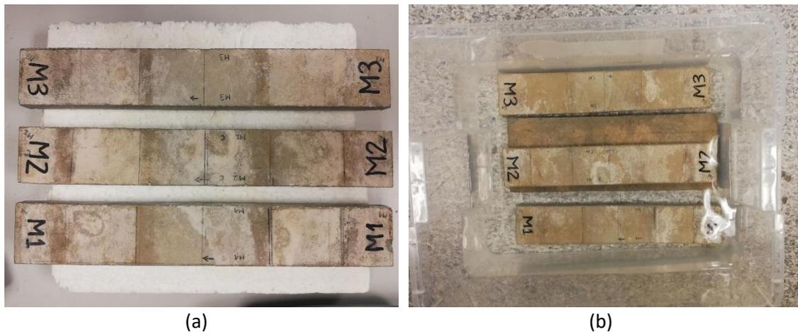
Figura 158. (a) Fotografía de las tres placas de GRC utilizadas en este estudio; (b) Placas en saturación.
