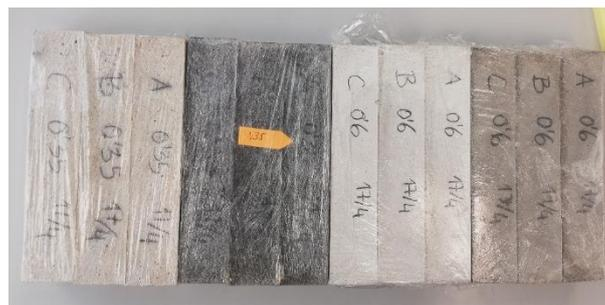
Figura 132. Probetas de mortero gris y blanco. Empezando por la izquierda: tres probetas de mortero blanco de  $w/c$  0.35, tres probetas de mortero gris de  $w/c$  0.35, tres probetas de mortero blanco de  $w/c$  0.6 y tres probetas de mortero gris de  $w/c$  0.6.
