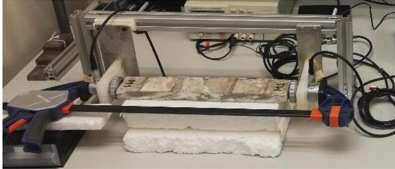
Figura 161. Montaje utilizado para las medidas de velocidad de onda P en las placas de GRC.
