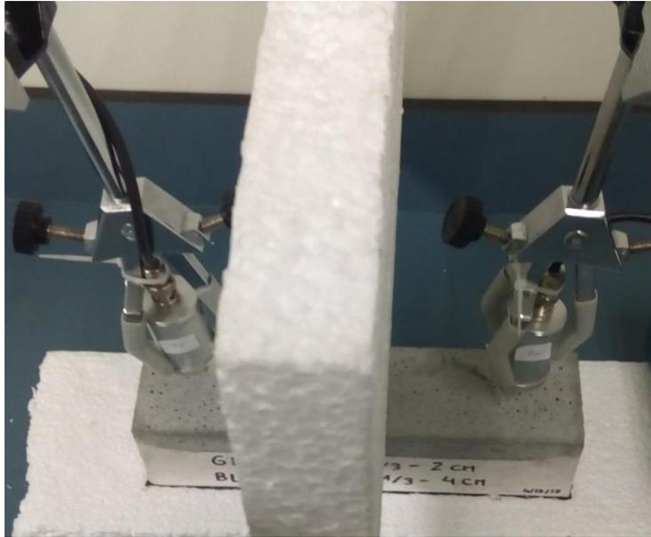
Figura 153. Acoplamiento por aire mediante transductores piezoeléctricos en la probeta de 20 mm de mortero gris y 40 mm de mortero blanco de la amasada 1.
