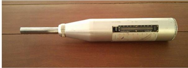
Figura 17. Martillo de rebote Schmidt ("*Schmidt hammer*" por [Arjuncm3](#), licencia bajo [CC BY-SA 3.0](#)).
