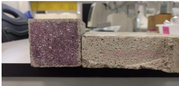
Figura 129. Ejemplo de probeta de mortero poco carbonatada (izquierda) y de probeta de mortero muy carbonatada (derecha).
