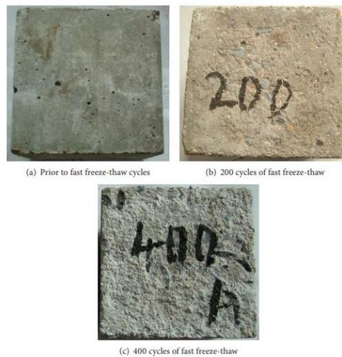
Figura 8. Ejemplo de ciclos hielo-deshielo aplicados en una probeta de hormigón: (a) 0 ciclos; (b) 200 ciclos; (c) 400 ciclos ("[FIGURE 1](#)", por [Huai-shuai Shang](#), Wei-qun Cao y Bin Wang, licencia bajo [CC BY 3.0](#)) (Shang et al., 2014).
