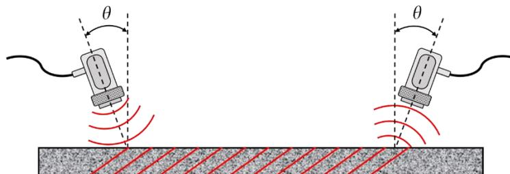
Figura 39. Configuración *pitch-catch* con incidencia oblicua.
