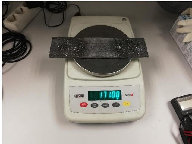
Figura 115. Medición de masa de la placa de mortero gris de 5 mm de espesor.
