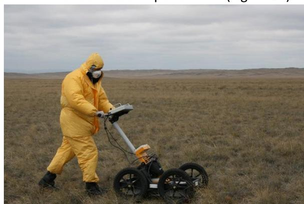
Figura 16. Ensayo por georradar ("[Using ground-penetrating radar](#)" por [The Official CTBTO Photostream](#), licencia bajo [CC BY 2.0](#)).
