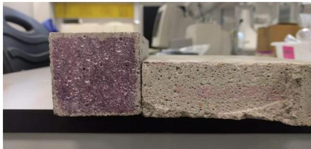
Figura 10. Ejemplo de probeta de mortero poco carbonatada (izquierda) y probeta de mortero muy carbonatada (derecha).
