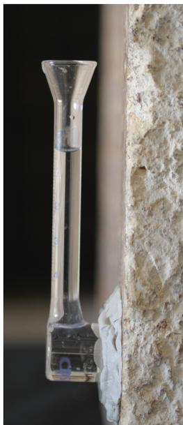
Fig. 34 Prueba de la pipeta Karsten. (Fotografía del autor).
