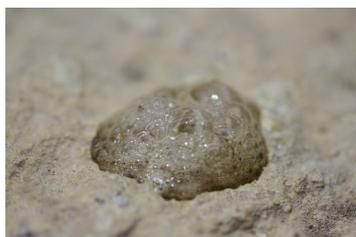
Fig. 36 Resultado del ácido clorhídrico (Fotografía del autor).
