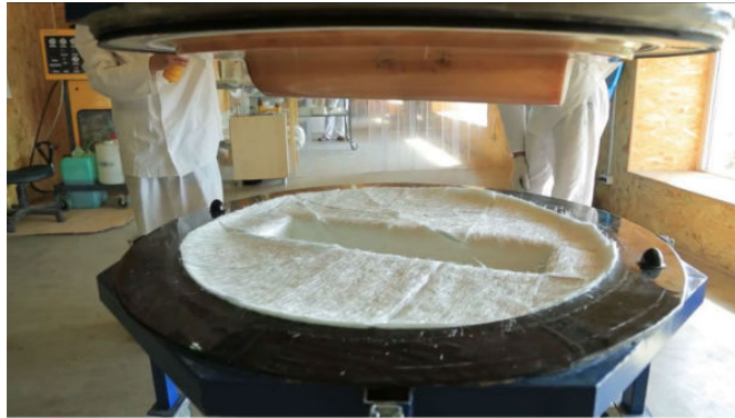
Figura 1.15: Fabricación de un componente por método de moldeo RTM en molde cerrado.
