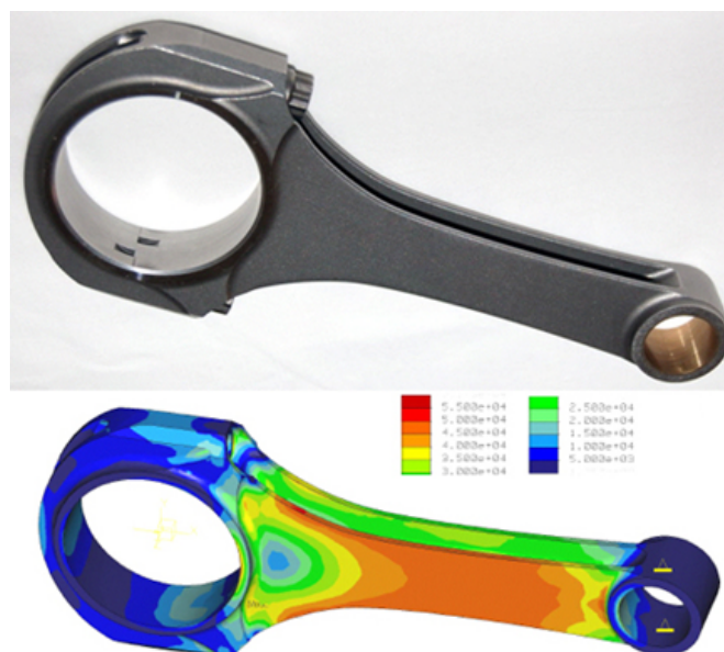
Figura 1.27: Simulación FEM de una biela.
