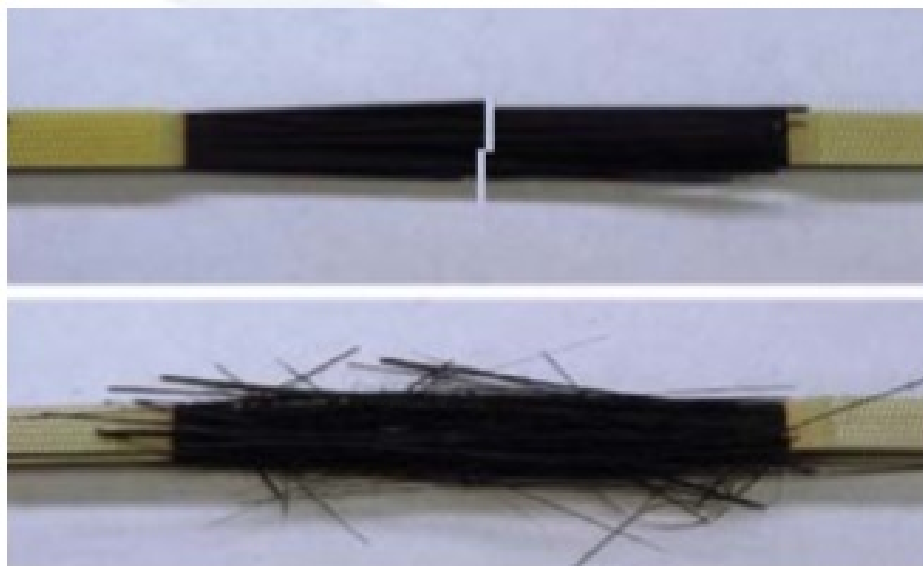
Figura 4.4: Tipos de rotura en tracción.
