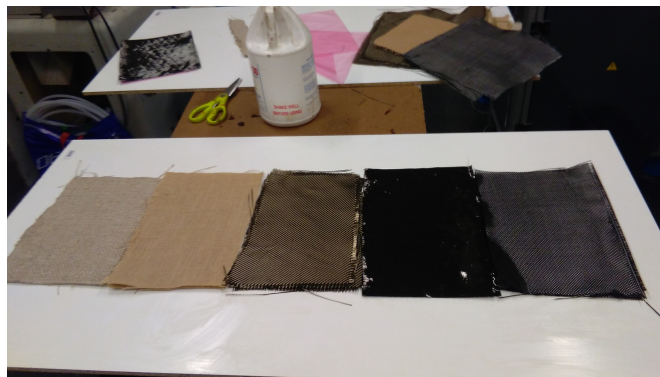
Figura 3.34: Proceso de fabricación. Posicionamiento de tejidos.
