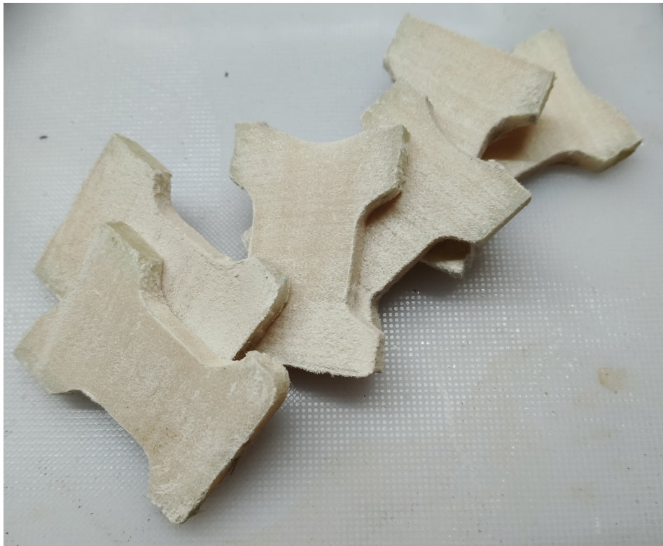
Figura 3.44: Probetas para ensayo de propiedades resistentes sobre el eje Z del laminado.
