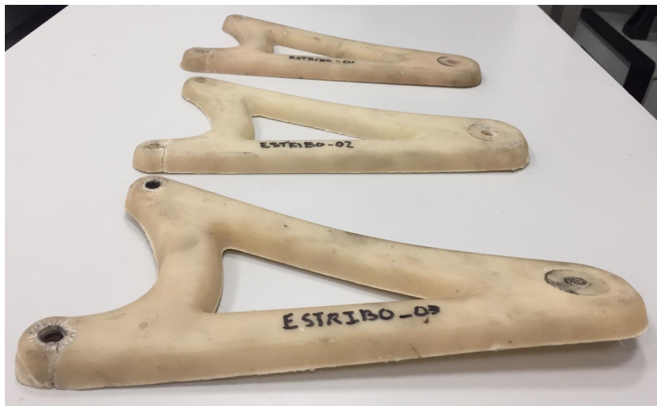
Figura 4.43: Estribos ensayados con la rotura en la misma zona.
