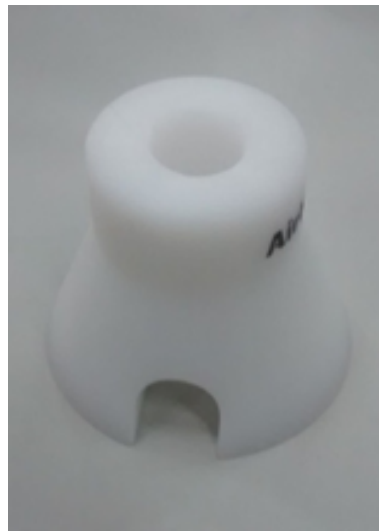
Figura 3.28: Toma para infusion de resina.
