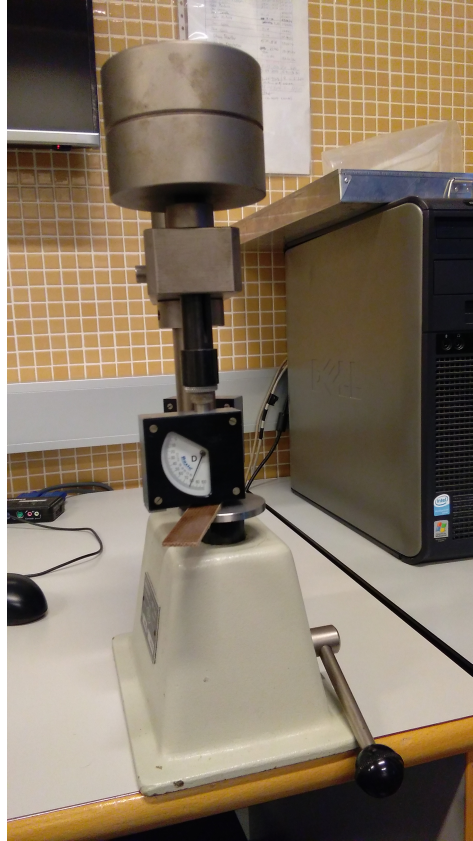
Figura 4.13: Medición de dureza sobre probeta de yute.
