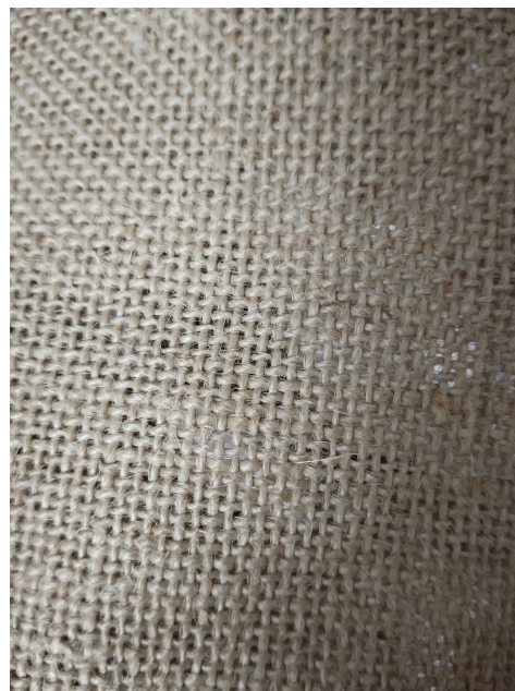
Figura 3.13: Tejido de fibra de yute utilizado.
