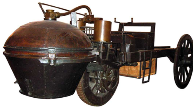
Figura 1.16: Fardier, primer automóvil con motor a vapor.
