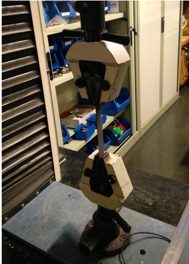
Figura 3.57: Ensayo de tracción realizado.
