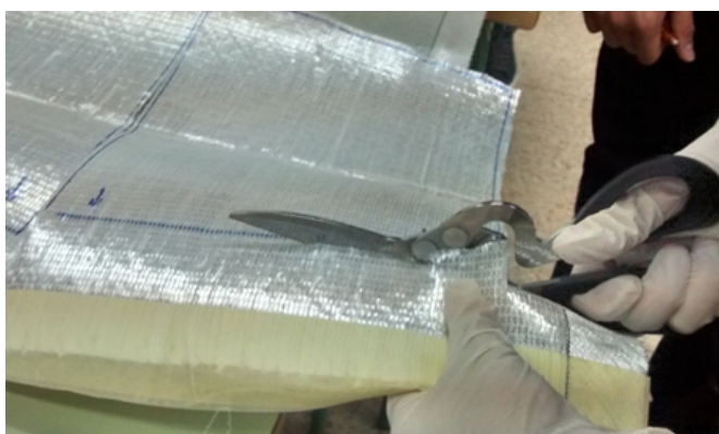
Figura 3.33: Proceso de fabricación. Corte de tejidos.
