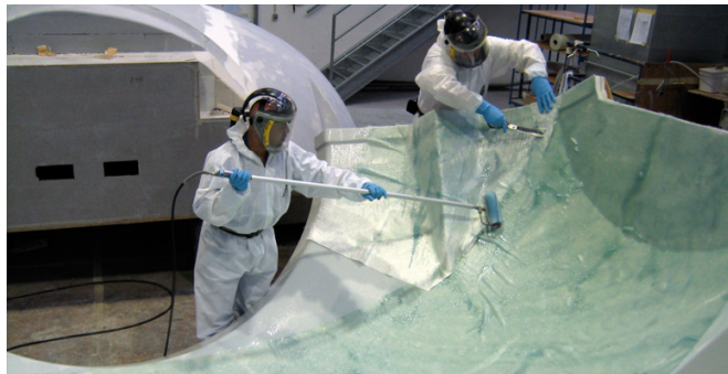
Figura 1.4: Moldeo por laminado manual.
