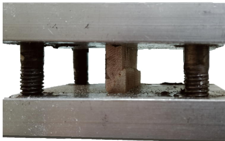
Figura 4.18: Fallo en probeta de bambú sometida a compresión.
