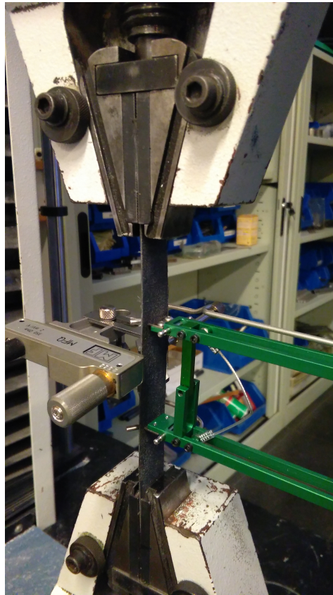
Figura 3.58: Montaje de extensómetro. Ensayo Poisson.
