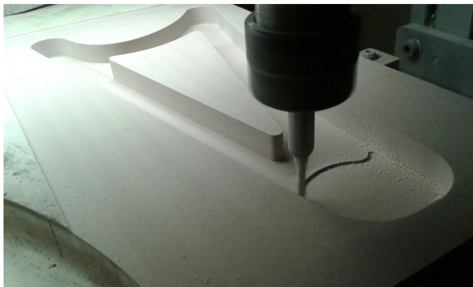
Figura 3.52: Mecanizado cnc del molde 1.
