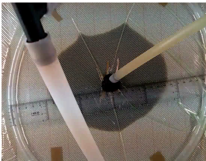
Figura 3.2: Ensayo radial de permeabilidad
