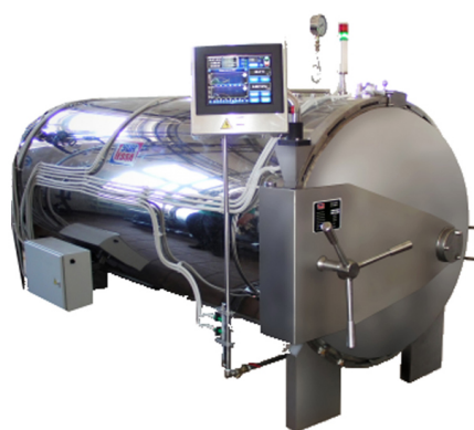
Figura 1.5: Horno autoclave para control de la presión y temperatura.
