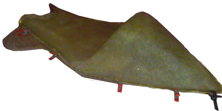
Figura 3.50: Molde del colín fabricado en dos partes.
