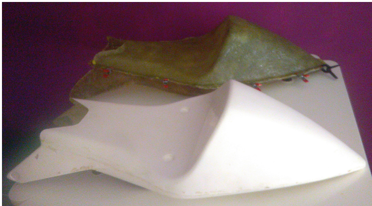
Figura 3.51: Prototipo de colín junto con molde desmontable utilizado.
