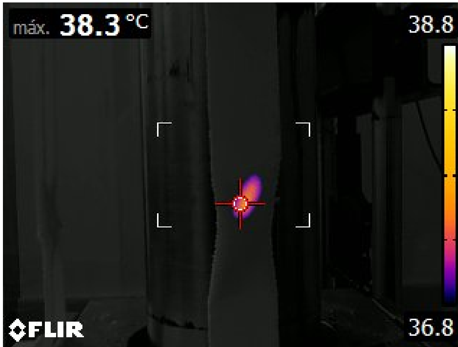
Figura 4.29: Imagen termográfica sobre probeta \pm 45^\circ en posición próxima a la rotura.
