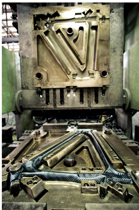
Figura 1.14: Moldeo por compresión en caliente del bastidor de una bicicleta de fibra de carbono.
