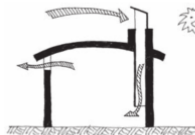
Figura 18. Chimenea de viento de una boca
