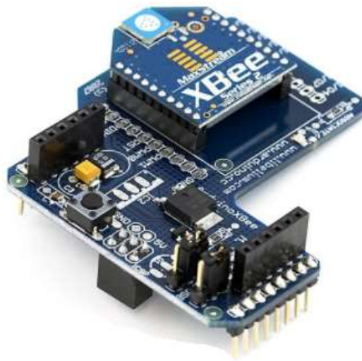
Figura 8 XBee conectado a la placa Shield
