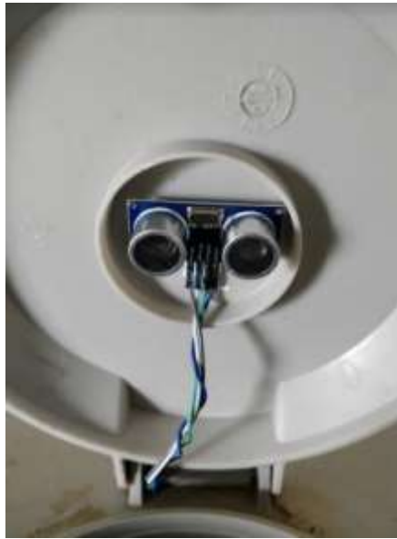
Figura 43 Colocación del sensor de ultrasonidos en tapa de depósito
