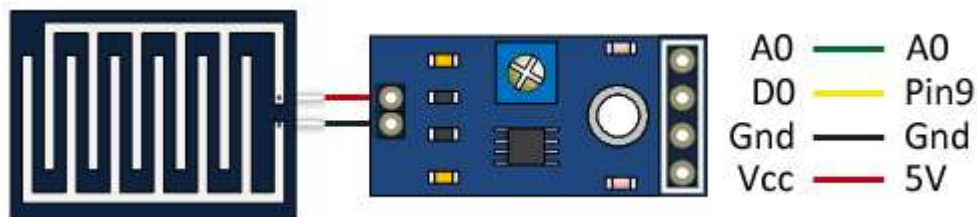
Figura 36 Conexiones del Sensor de Detección de Agua y Potenciómetro
