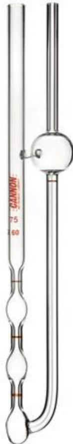
Figura 6: Viscosímetro capilar Canon-Fenske para fluidos opacos
