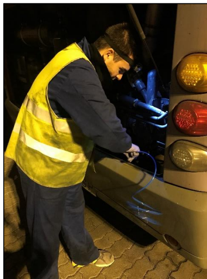
Figura 12: Introducción del tubo de poliuretano en el cárter
