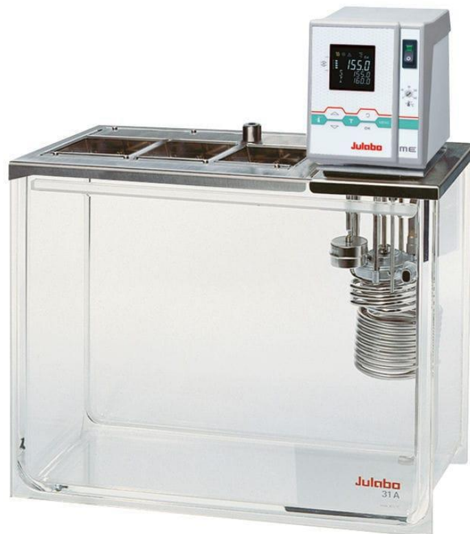
Figura 5: Baño termostático con control de temperatura digital
