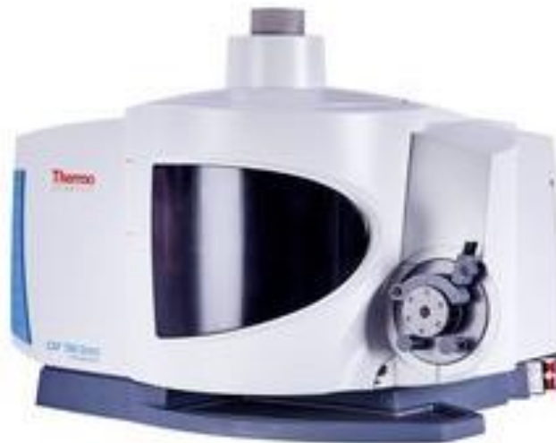
Figura 10: ICP-OES de Thermo Scientific, modelo iCAP 7400 con configuración radial
