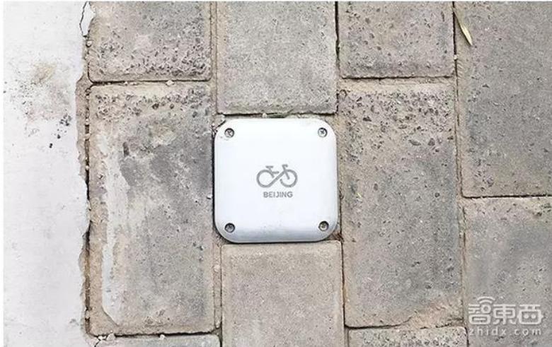
Figura 11: Localizador de cerca electrónico inalámbrico muy pequeño incrustado en el suelo. (FUENTE: Che dongxi)
