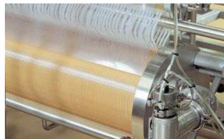
Figura 6. Ejemplo de membrana de tipo plana. Imágenes tomadas de tetrapack.com.es
