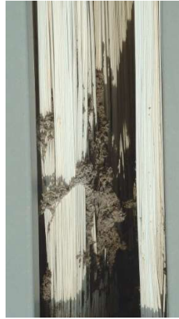
Figura 12. Problemas de taponamiento en membrana de fibra hueca en un reactor MBR. Imagen tomada de MBRsite.com
