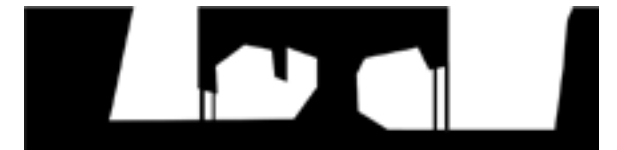
Figura 29. Excavación vertical + excavación horizontal.
