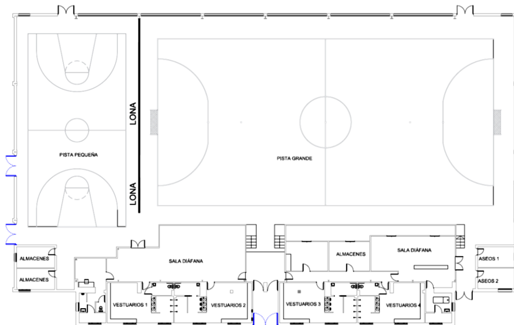
Figura 3 Distribución planta baja
