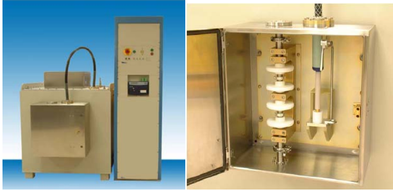
Figura II.7. Equipo comercial de PEAI y sistema de cámaras co-field para tratamiento de aguas residuales desarrollado por DTI.
