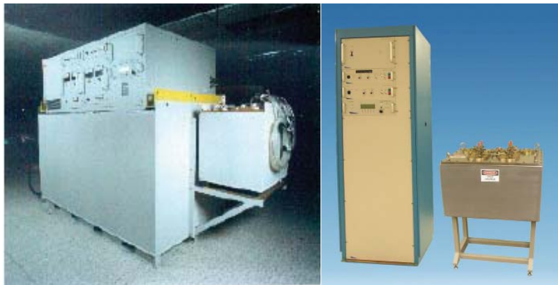
Figura II.8. Equipos desarrollados por DTI para la Ohio State University (izq.) y la Universidad de Salerno (dcha.) capaces de tratar 5000 l/h y 400 l/h respectivamente.
