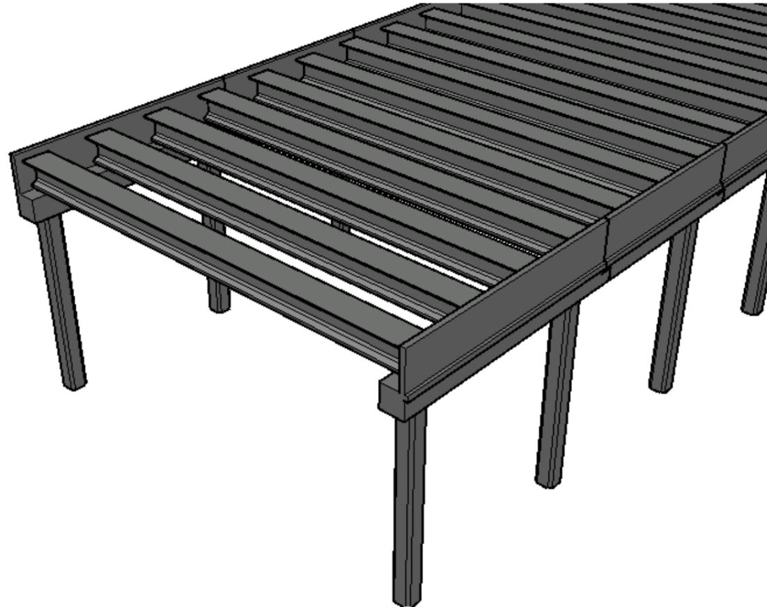
Figura 11. Perspectiva pórticos ALTERNATIVA 2. (Fuente. Elaboración propia en software AutoCad).
