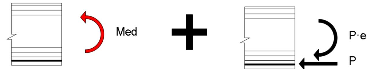
**Figura 88.** Aplicación de pretensado en sección de viga de estudio ALTERNATIVA 2 (Fuente. Elaboración propia en *software* AutoCad).
