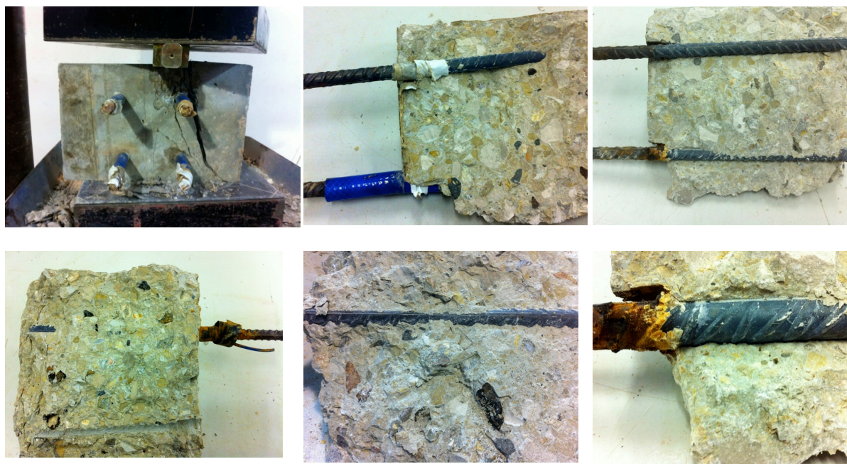
Figura 8.43. Probetas de hormigón armado sometidas a rotura para observar las armaduras embebidas.
