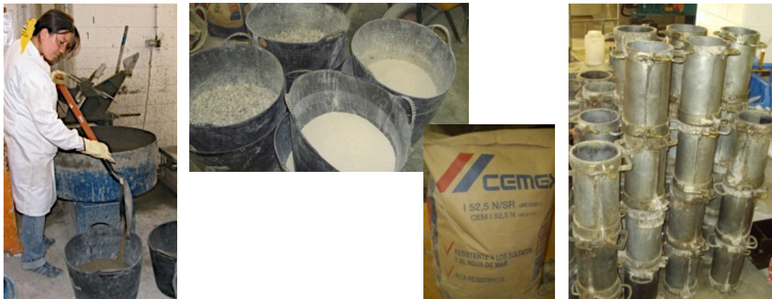
Figura 5.8. Se preparan las materias primas y los materiales a emplear (probetas, cronometro, termómetro, cono, etc.)
