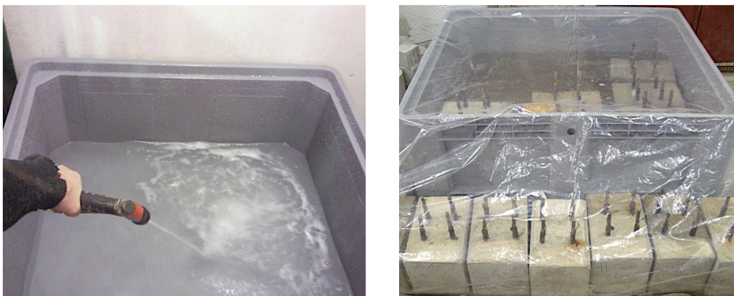
Figura 5.40. Preparación de agua de mar para simulación del ataque en hormigón armado. Y probetas sometidas al ambiente agresivo.
