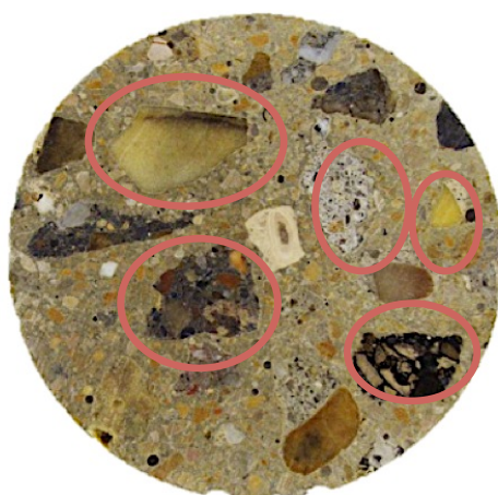
Figura 2.15. Diferentes tipos de árido reciclado en la matriz de un hormigón a_{ef}/c 0,45 con 100% de árido reciclado.
