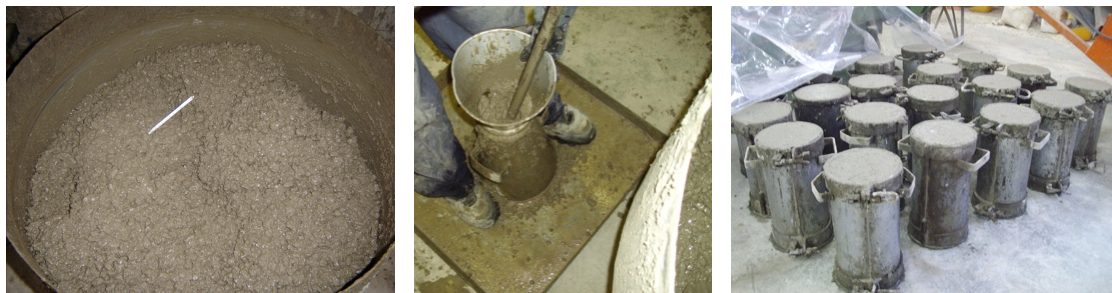
Figura 5.12. Se mide la temperatura del hormigón, se hace el cono para evaluar la consistencia del hormigón (consistencia blanda, entre 60-90mm) y si es adecuado se fabrican las probetas.
