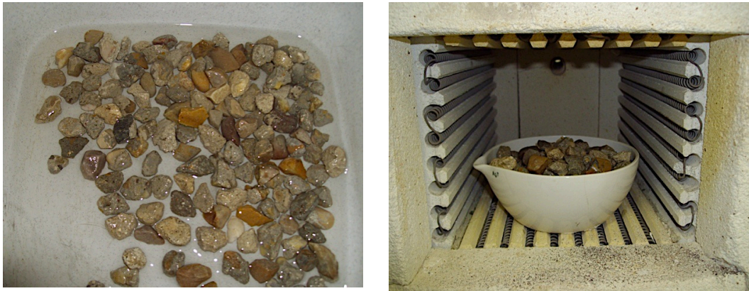
Figura 5.6. Procedimiento de choque térmico en los áridos reciclados.
