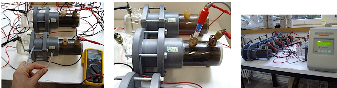
Figura 5.30. Ensayo según la norma UNE 83987: 2009 en marcha, toma de voltaje, lecturas de Conductividad y temperatura
