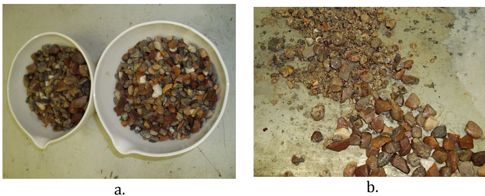
Figura 5.7. Detalles del ensayo. a) Fracciones utilizadas. b) Áridos sometidos a machaqueo para desprender el mortero adherido.
