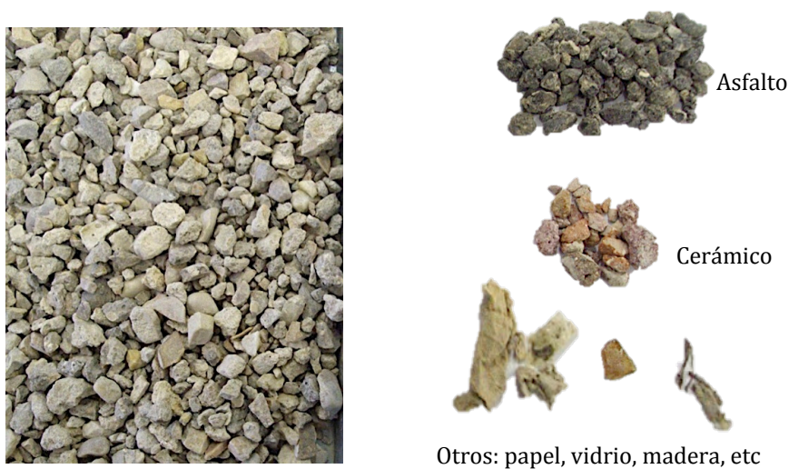
Figura 5.5. Separación de los componentes del árido reciclado (áridos naturales y hormigón, asfalto, materiales de albañilería, papel, madera, vidrio).
