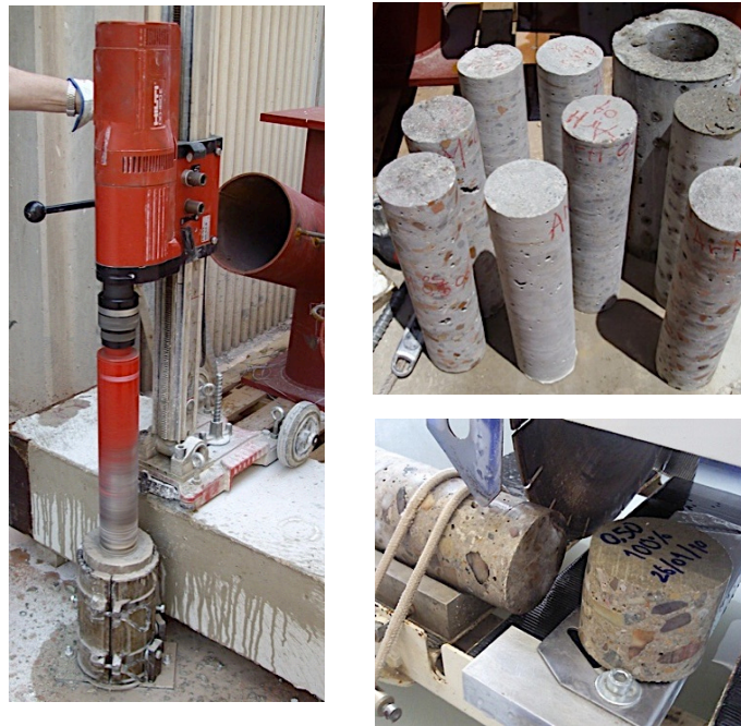
Figura 5.26. Extracción de testigos y corte de muestras para el ensayo de Difusión de Cloruros.
