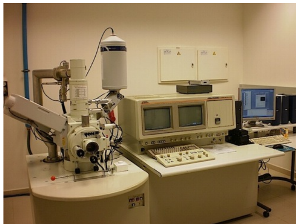
Figura 5.19. Microscopio electrónico de barrido (SEM) modelo JEOL JSM6300. Universitat Politècnica de València.
