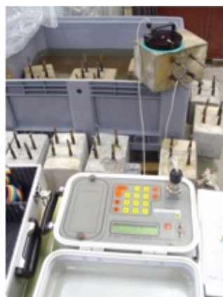
Figura 5.39. Probetas para la evaluación de la corrosión. a) Montaje para la fabricación de las probetas. b) toma de lecturas E_{corr} e I_{corr} .
