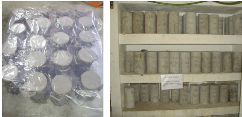
Figura 5.13. Las probetas se mantienen 24h cubiertas, luego son retiradas de los moldes, marcadas y almacenadas en la cámara húmeda.
