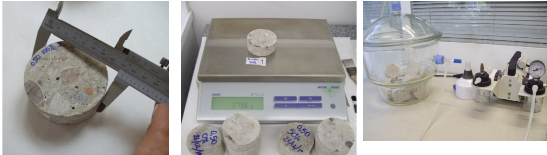
Figura 5.28. Toma de diámetros, espesores y pesos de las probetas, y puesta en vacío y saturación de las muestras.
