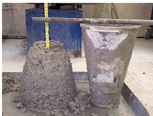
Figura 5.15. Ensayo de asentamiento con los hormigones estudiados.
