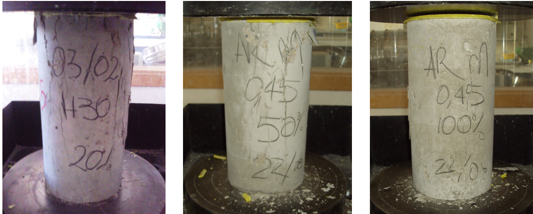
Figura 6.3. Roturas satisfactorias en las probetas sometidas a ensayo.
