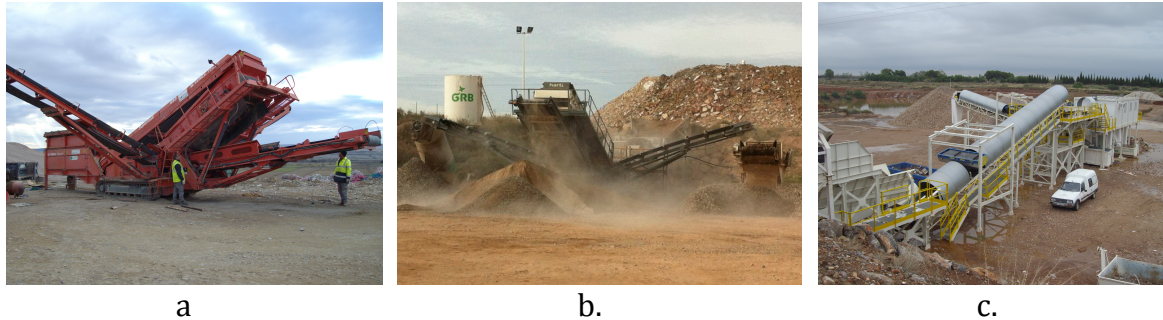
Figura 2.5. Plantas de gestión de residuos en España. a) Móvil. b) Semi- móvil. c) Fija.
