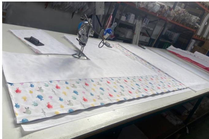
ILUSTRACIÓN 76: MESA DE CORTE (FUENTE: IMAGEN PROPIA)
