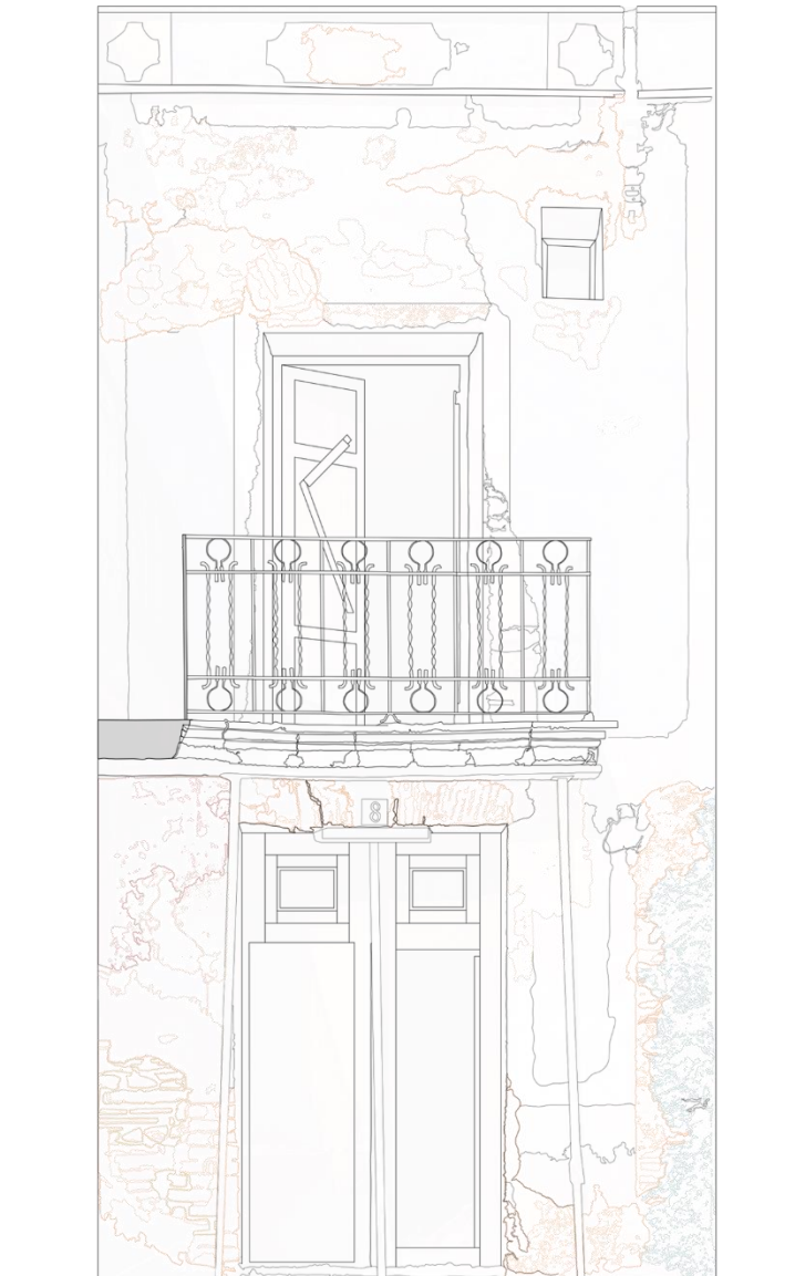
[Fig. 119] Mapejat façana principal. Font: Elaboració pròpia. 2020.
