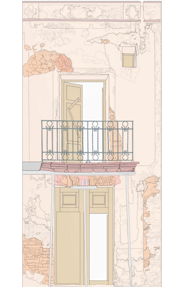
[Fig. 103] Mapejat façana principal. Font: Elaboració pròpia. 2020.
