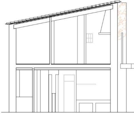
[Fig. 128] Situació de l'efecte de quarterat del revestiment exterior. Font: Elaboració pròpia. 2020.
