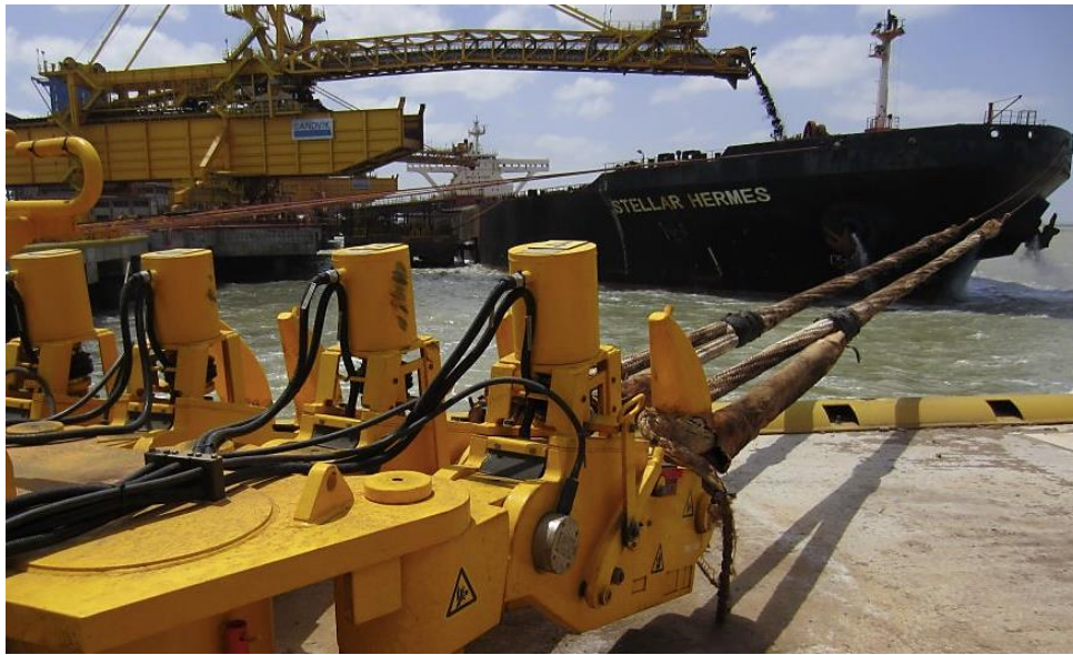
Ilustración 69. Quick Release Mooring Hook en Sao Luís Brazil. Mampaey
