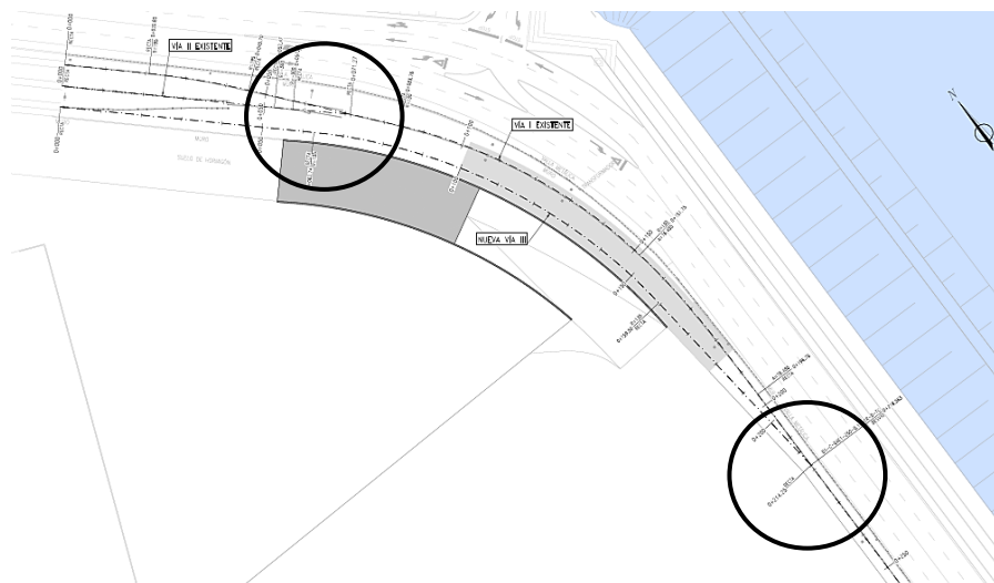
Ilustración 119. Vía ferroviaria en Terminal TMS. Desvío 4 y desvío 3 modificado entre parcelas 19.1 y 19.2.
