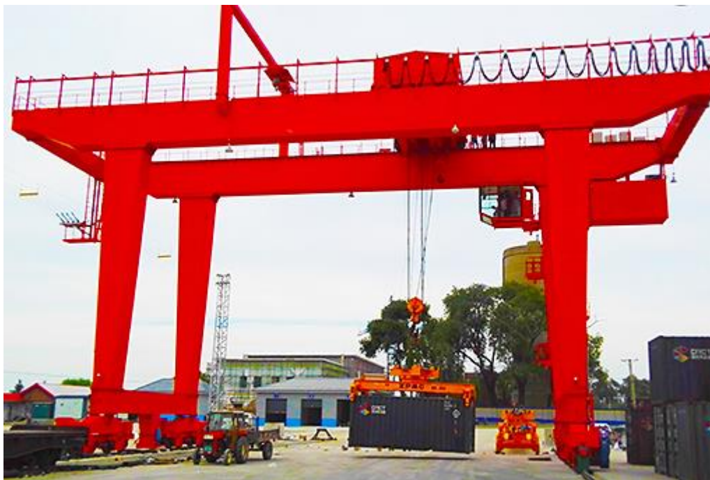
Ilustración 33. Grúa pórtico para contenedores AR-RMG
