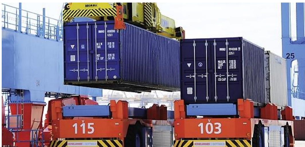
Ilustración 82. AGVs de KoneCranes en la línea de atraque
