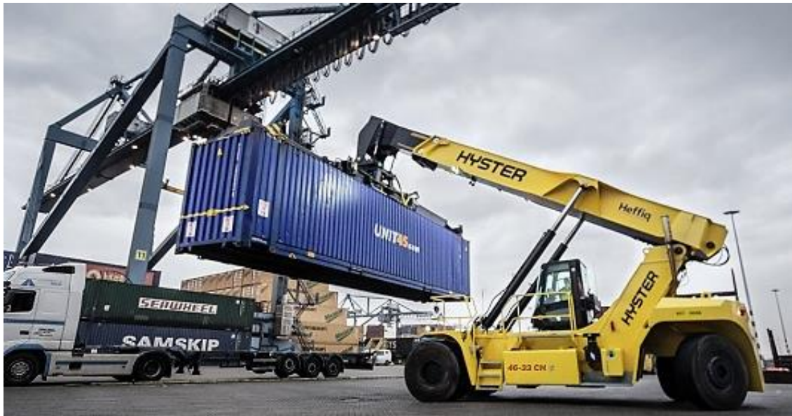
Ilustración 28. Ejemplo de reachstacker de Hyster
