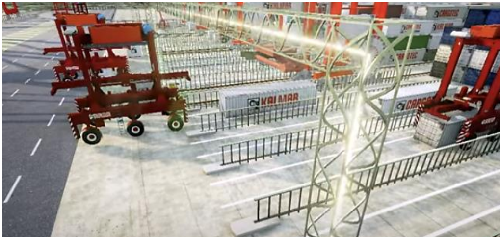
Ilustración 111. Representación de la estación de carga rápida del Shuttle Carrier
