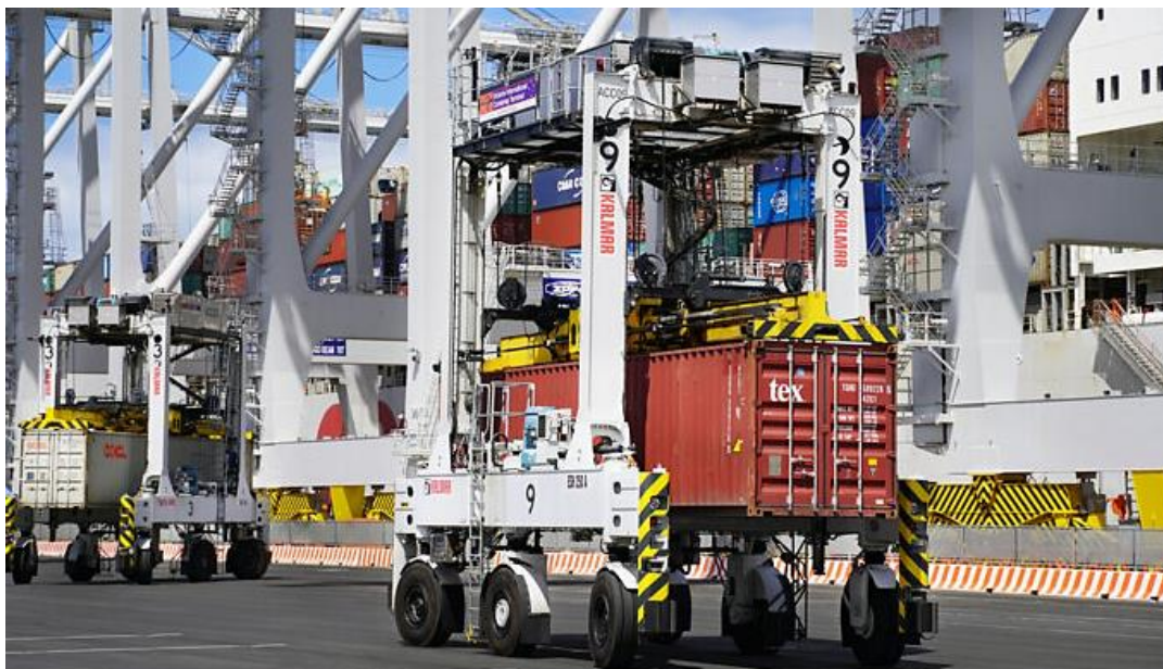
Ilustración 110. Autosshuttle como equipo para realizar la interconexión muelle-patio.
