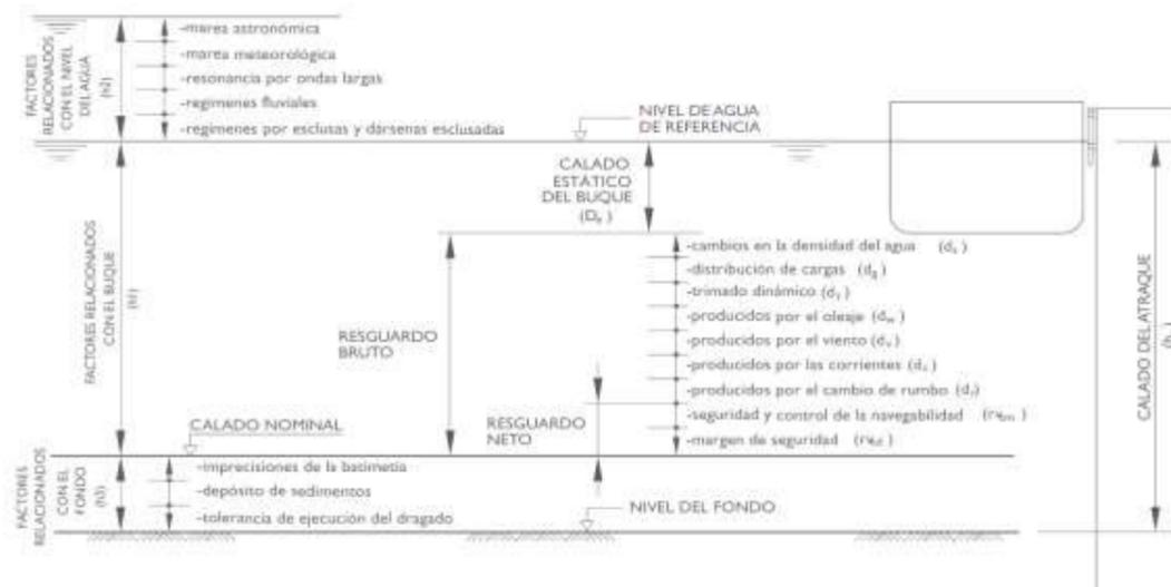
Ilustración 2. Factores que influyen en la definición del calado de la línea de atraque. Fuente: ROM 0.2-11.
