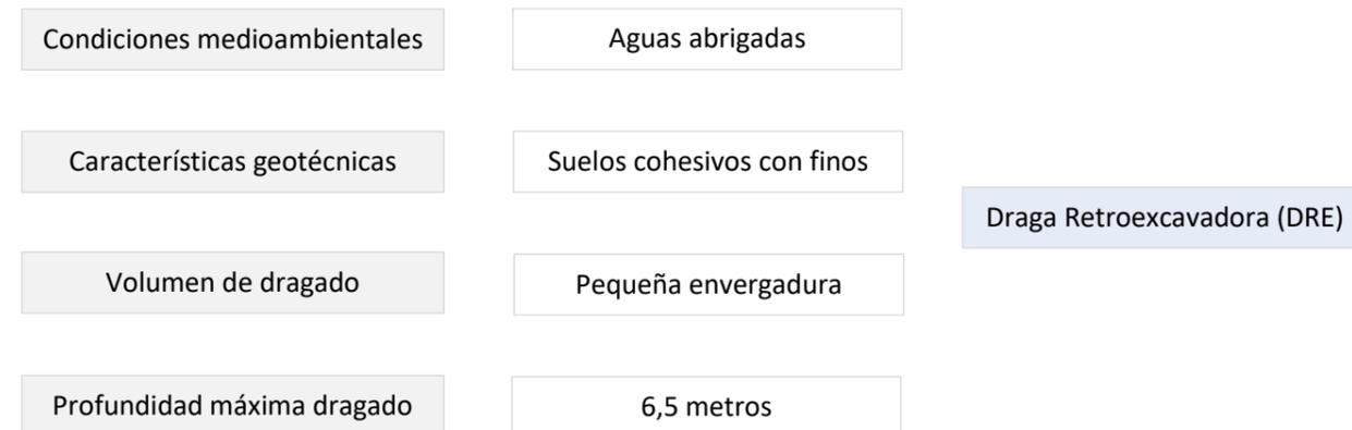
Una draga retroexcavadora (DRE) es una excavadora marina desarrollada a partir de la retroexcavadora terrestre. Está conformada por una excavadora hidráulica con un cazo instalado en el extremo del brazo articulado formado por dos piezas. El término retroexcavadora hace referencia a la acción de la pala, que excava arrastrando la tierra hacia atrás, en lugar de recoger el material con un movimiento de avance, como en el caso de una pala.
