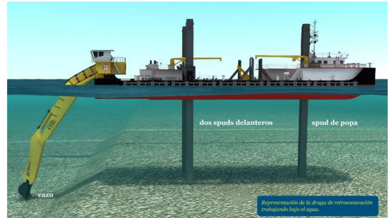
Ilustración 2. Esquema de la draga retroexcavadora (DRE). Fuente: IADC.
