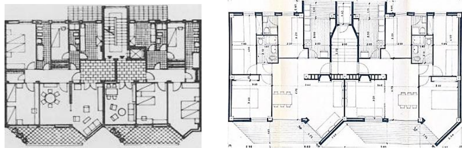
Figura 65. Comparativa de las plantas del edificio Julio G. Lafuente y Gaetano Rebecchini en Roma (parcial), y el edificio de Miguel Colomina en Jávea. Rasgos como el diseño del estar ampliado con el voladizo en la vivienda de la izquierda y el dormitorio ampliado de la vivienda de la derecha, así como el cuerpo volado trasero con los lavaderos y la caja de escalera delatan la deuda del segundo respecto al primero.
