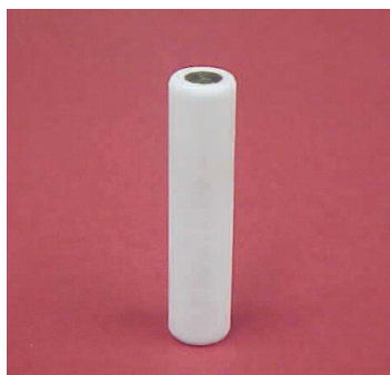
Figura 4.3 Imagen del material sustrato acero inoxidable AISI 304 (electrodo de trabajo).
