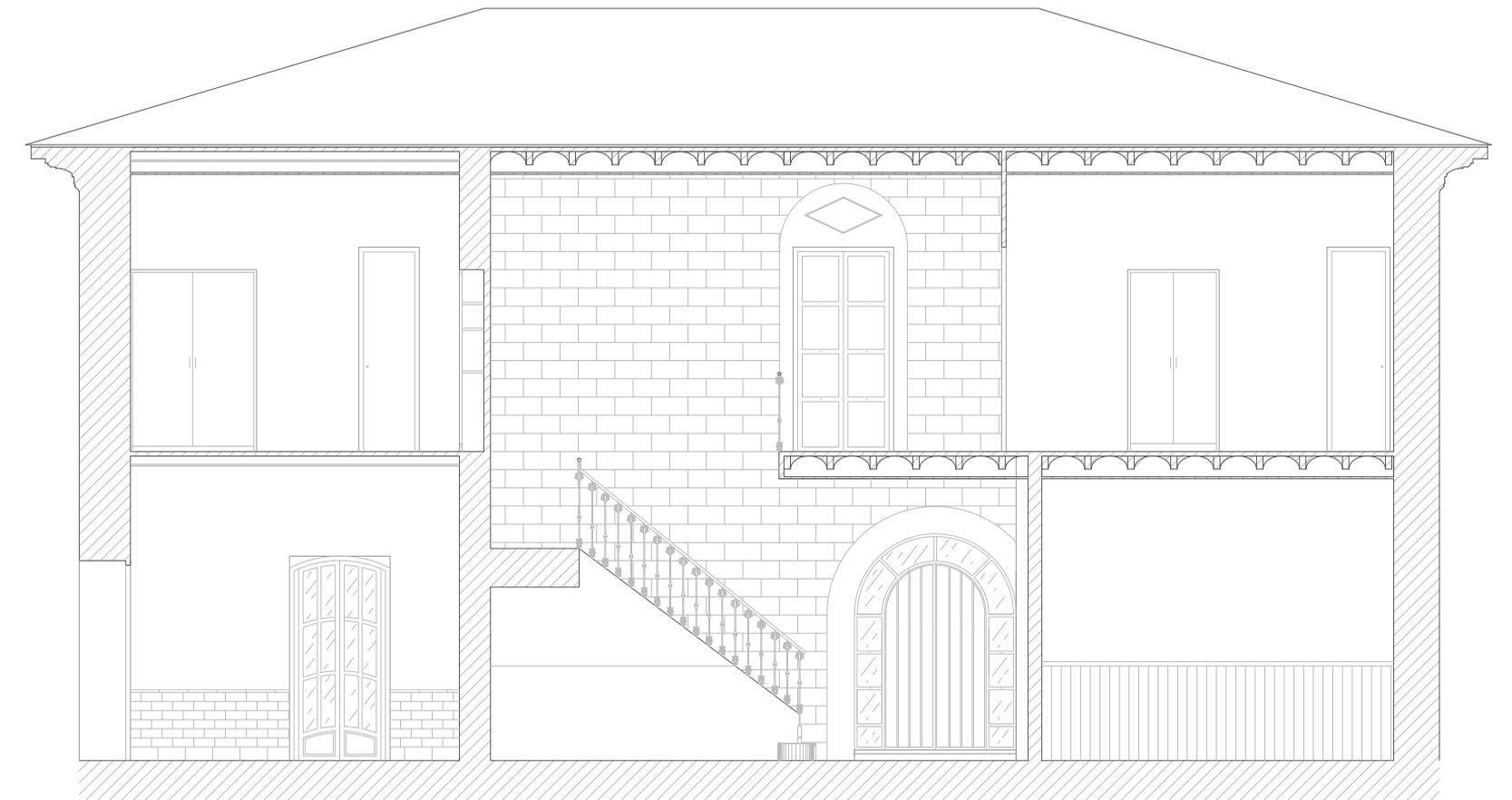
Fig. 28. Sección transversal por hueco de escalera, escala 1/75. Fuente: Elaboración propia
