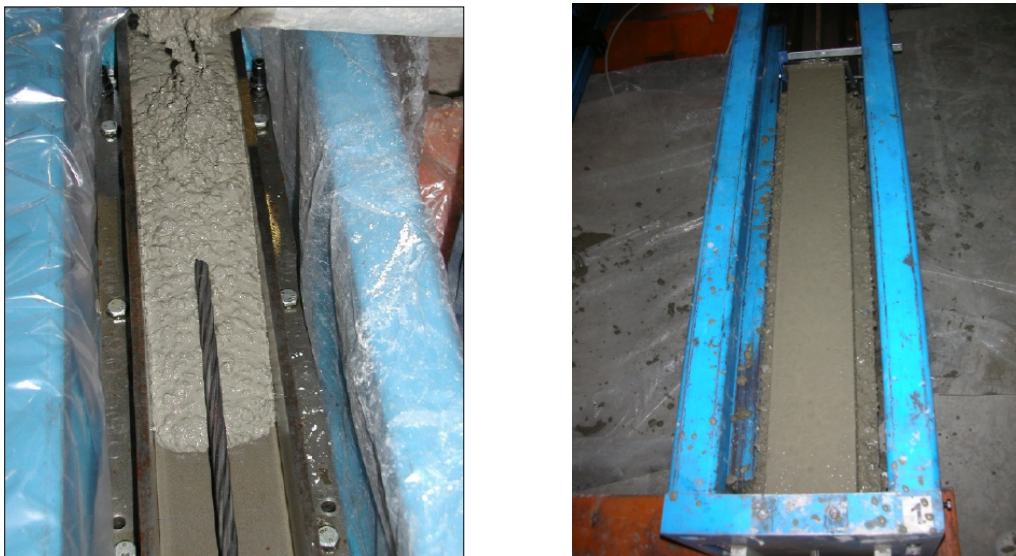
Fotografía 4.4.1.1. Hormigonado de la probeta.
