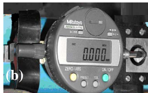
Fotografía 4.3.8. (a) Discos de extensometría mecánica. (b) Equipo de medición DEMEC.
