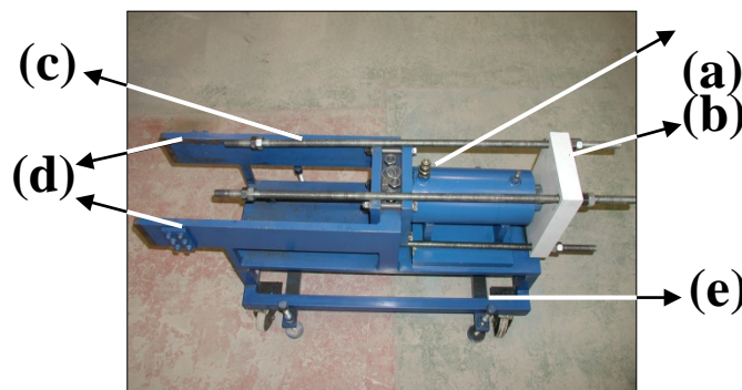
Fotografía 4.2.5. Gato hidráulico para operación de arrancamiento. (a) Gato hidráulico. (b) Placa de empuje. (c) Varilla de tracción. (d) Elementos de apoyo. (e) Soporte desplazable.
