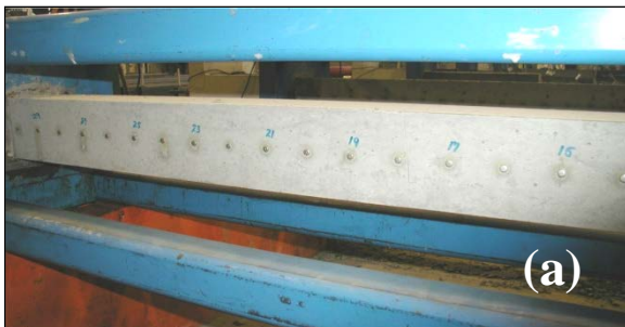
Fotografía 4.3.8. (a) Discos de extensometría mecánica. (b) Equipo de medición DEMEC.
