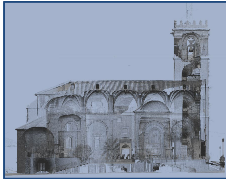
Figura 4.139- Imagen (tif) obtenida a partir de la nube de puntos, de la sección longitudinal, con las proyecciones de los objetos más allá de la sección. (2018)
