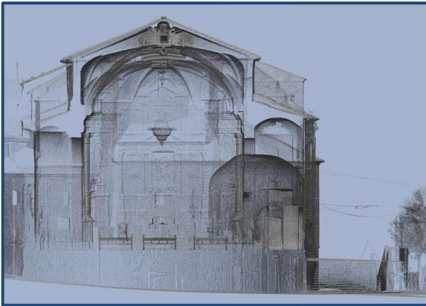
Figura 4.138- Imagen (tif) obtenida a partir de la nube de puntos, de la sección transversal, con las proyecciones de los objetos más allá de la sección. (2018)
