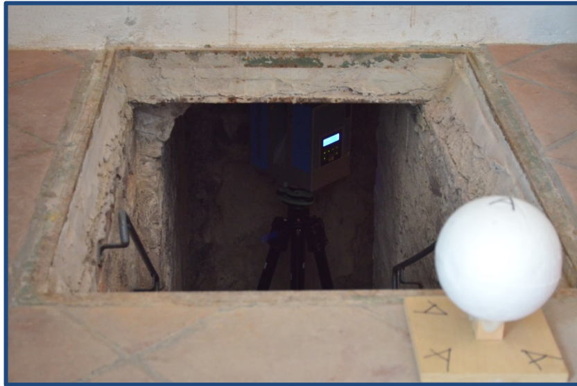
Figura 1.16. Diana, (“target”), esférica de poliestireno en primer término, y el escáner en la cripta de Foiano de la Chiana. Nos servirá para unir nubes de puntos interiores, con las exteriores. (2015).
