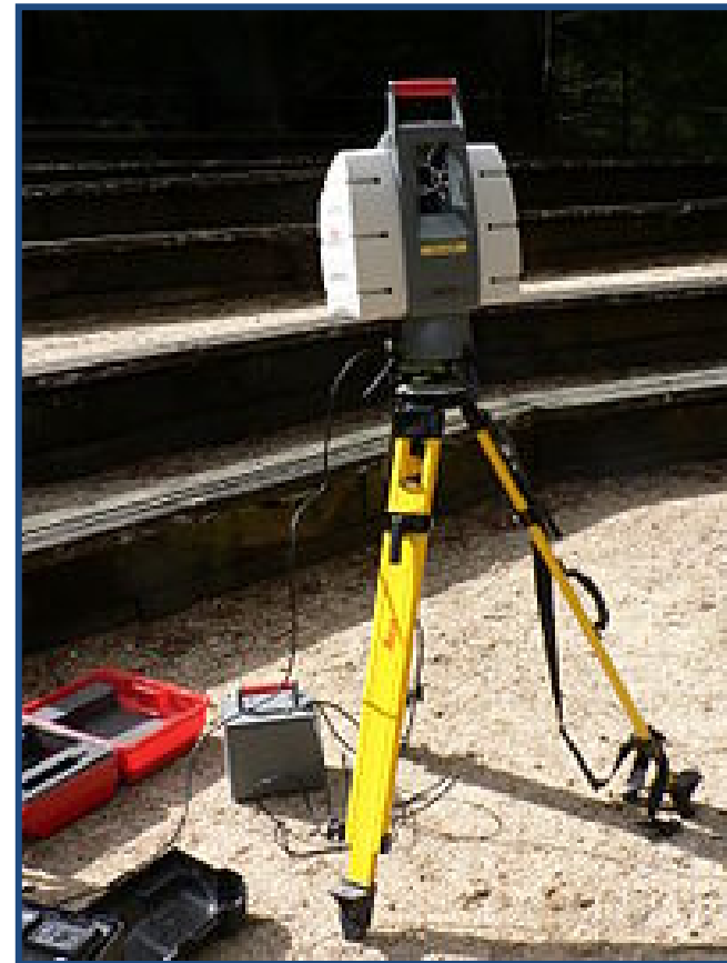
Figura 1.9.. Escáner marca Leica sobre trípode, utilizado en el escaneado de la iglesia de Alberic (2010).
