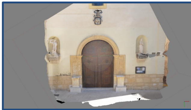
Figura 1.11. Pantalla programa Photoscan, con primeras pruebas fachada exterior Massalavés. (2015).
