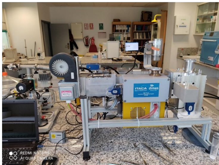
Figura 2. 2 Microondas de cavidad circular
