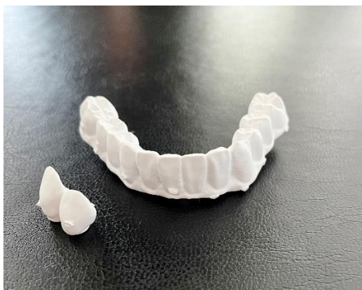
Figura 3. 1 Implantes dentales antes del proceso de sinterización
