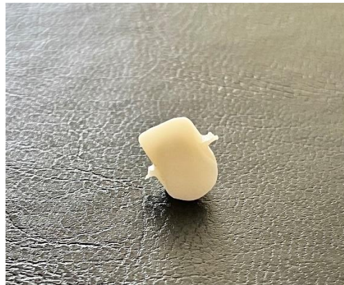
Figura 3. 4 Implante dental después de la sinterización
